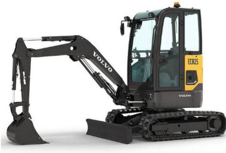
Figure 2.1: Volvo Mini Excavator
