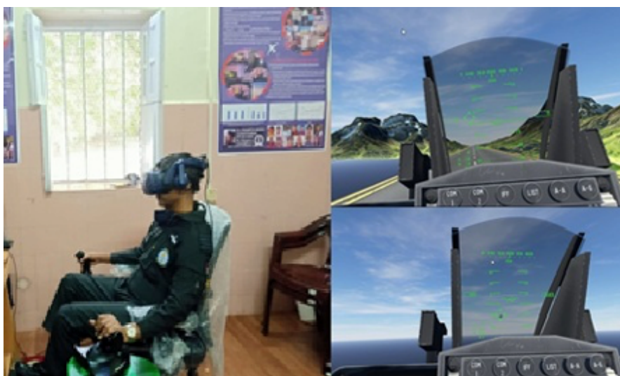
Figura 2.5: Simulatore di volo in realtà virtuale descritto nello studio [17]: configurazione hardware (a sinistra). Rendering visuale sull'HMD a terra (in alto a destra) e durante il tracciamento del bersaglio (in basso a destra).
