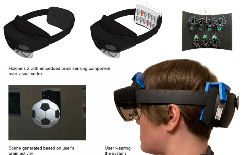
Figura 2.10: Con riferimento allo studio Riferimento allo studio [30]: Auricolare HoloLens 2 AR con componente di rilevamento delle onde cerebrali incorporato (supporto clip-on EEG sopra la corteccia visiva e prefrontale, due elettrodi EEG evidenziati in arancione); Un'immagine ravvicinata del supporto clip-on con 7 elettrodi; Utente che indossa un sistema "migliorato" AR-BCI (clip-on in blu sopra la corteccia visiva e pre-frontale); Una rappresentazione visiva della palla da calcio che viene generata quando l'utente è impegnato nel gioco.
