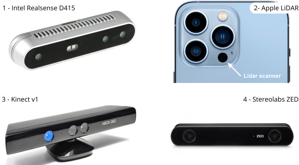
Figura 2.3: Esempi di camere di profondità: 1) ToF; 2) LiDAR; 3) A luce strutturata; 4) Stereo vision
