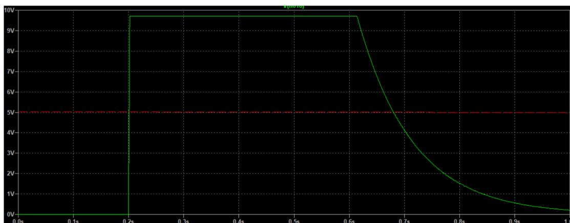
**Figura 3.28:** Risultato della simulazione sul transitorio del circuito finale di trattamento della tensione di inserzione per la valutazione del tempo di scarica del condensatore nel caso peggiore
