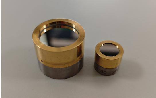
**Figura 2.2:** Microfoni a condensatore LS1 ed LS2
