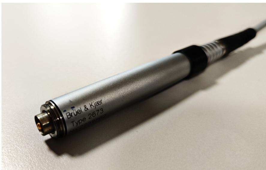
**Figura 3.4:** Preamplificatore Brüel & Kjær tipo 2673
