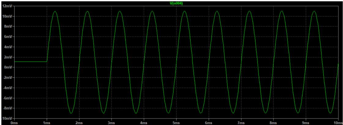
**Figura 3.22:** Risultato della simulazione sul transitorio del circuito di condizionamento dei segnali microfonici con ingresso singolo a 10 mV e guadagno 0 dB, con ingresso acceso con un ritardo di 1 ms
