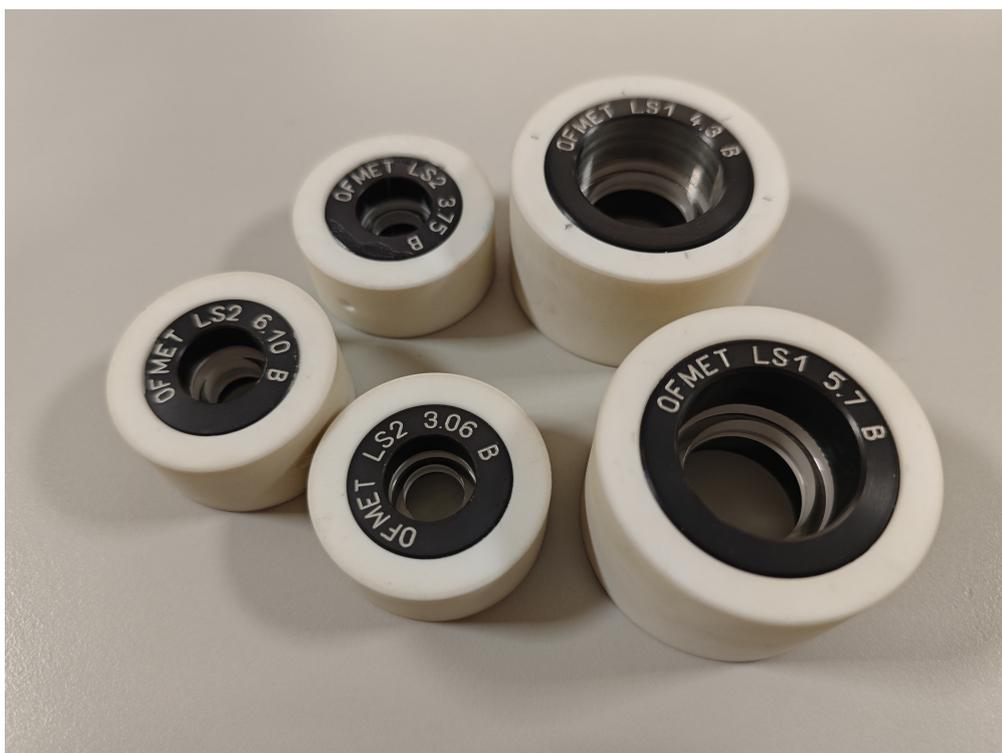
**Figura 2.9:** Accoppiatori acustici per microfoni a condensatore da 1" e  $\frac{1}{2}$ ", realizzati in zaffiro ed utilizzati nel sistema di taratura per reciprocità in pressione presente all'INRiM
