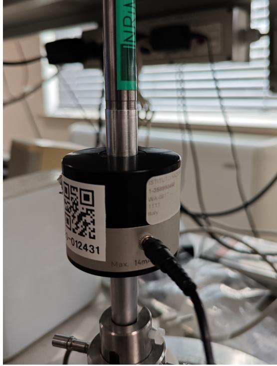
**Figura 4.23:** Microfono MEMS in taratura per confronto simultaneo in pressione con microfono LS2
