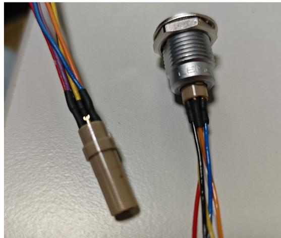
**Figura 4.11:** Connettori saldati a ponticelli protetti da membrane plastiche termo-restringenti
