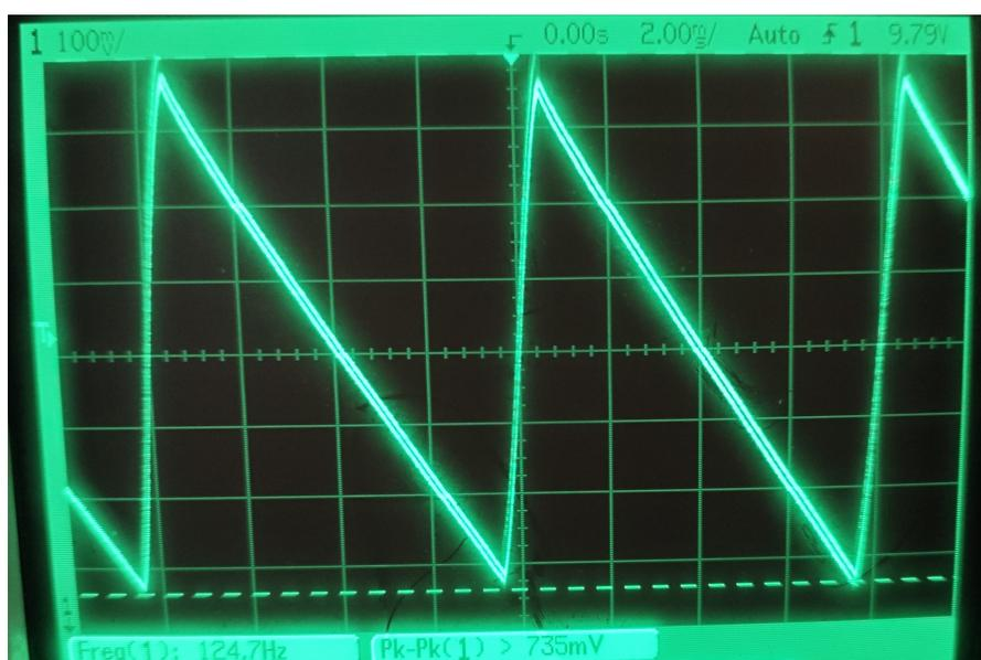
**Figura 4.8:** Ripple in uscita dal peak detector con ingresso di  $20\text{ mV}_{\text{rms}}$  alla frequenza 125 Hz
