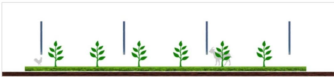
Figura 19 - Impianto agrivoltaico in cui i moduli sono disposti verticalmente. La coltivazione e il pascolo degli animali avvengono tra le file dei moduli fotovoltaici (fonte: MiTE, 2022)
