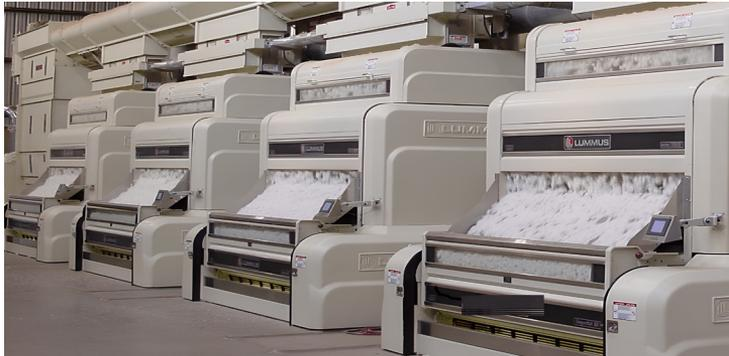
Fig. 2 - Processo di sgranatura del cotone, dove i semi vengono separati dalle fibre.
