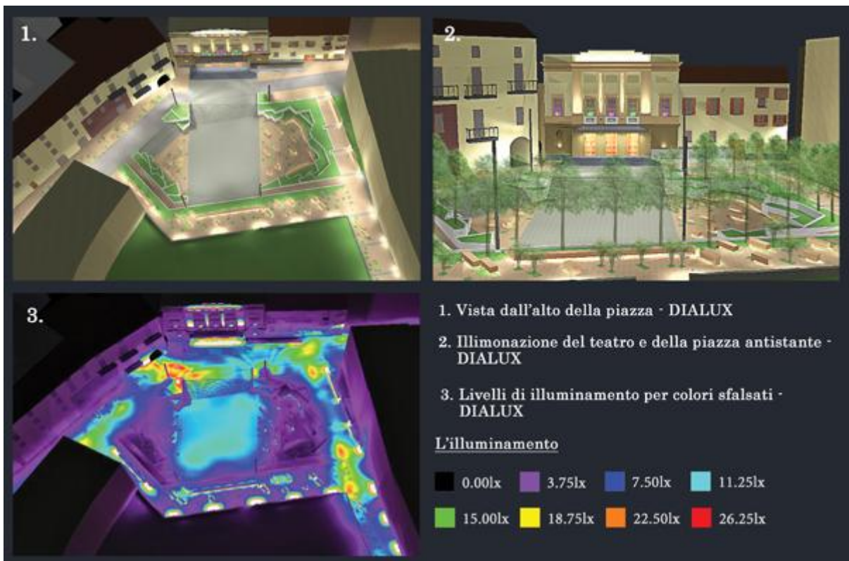
Vue 3d du projet d'éclairage_DIALUX
