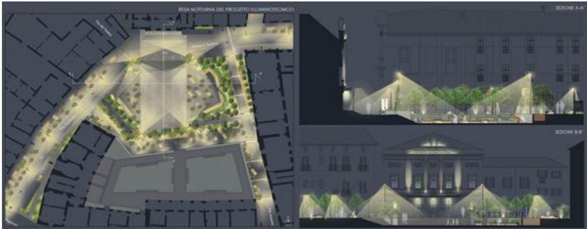
Projet de conception d'éclairage: le plan et coupe
