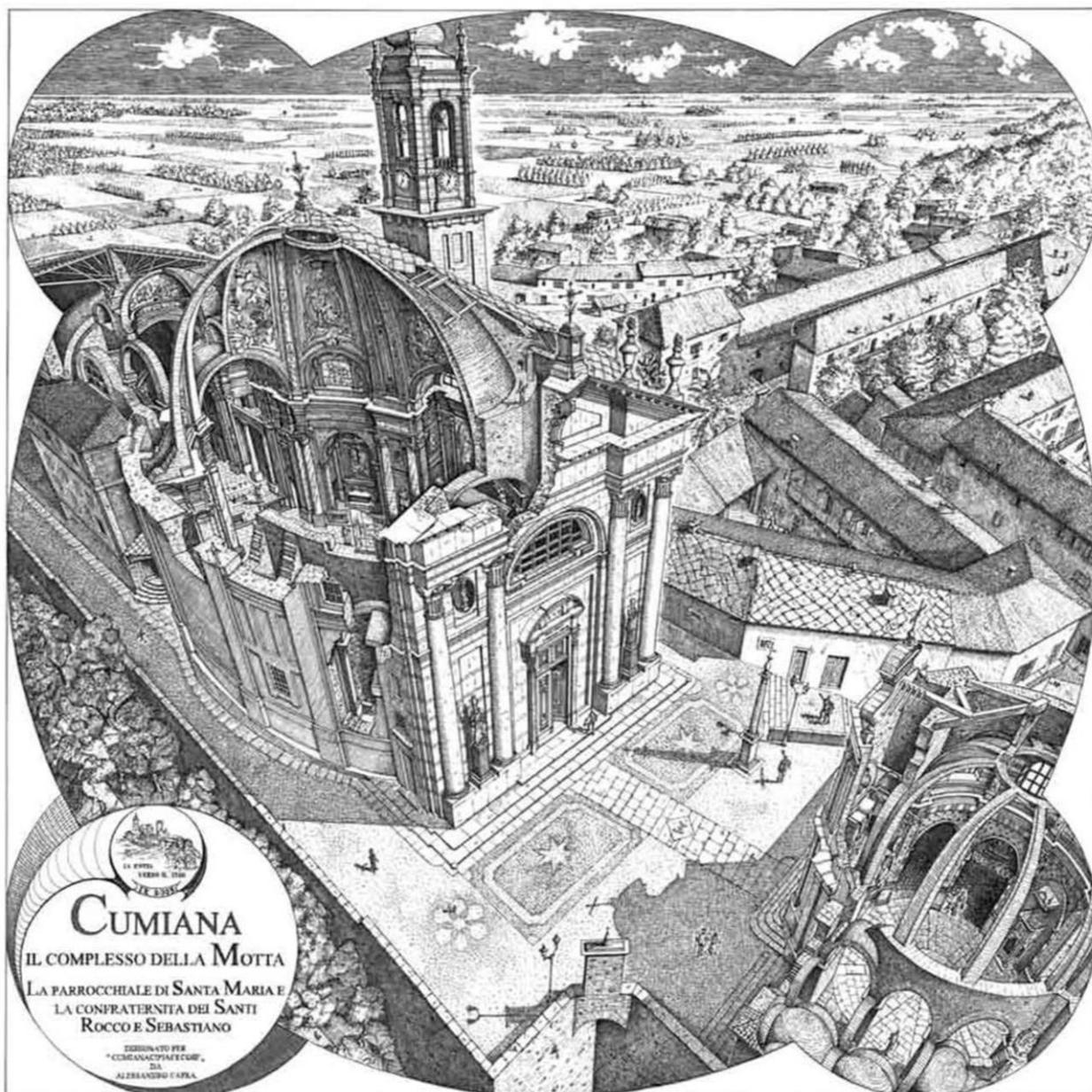
Figura 40 – Spaccato assometrico di Santa Maria della Motta e una parte della Cappella di San Rocco (Galleria disegni architettonici; 2003 china su lucido 60x60cm, di Alessandro Capra).
