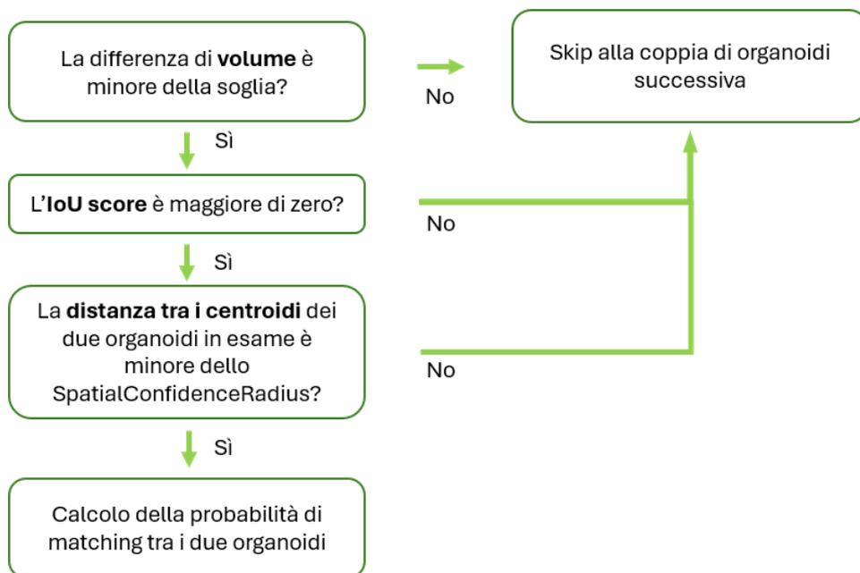
**Figura 3.3:** Workflow dei criteri di matching nell'algoritmo di tracking
