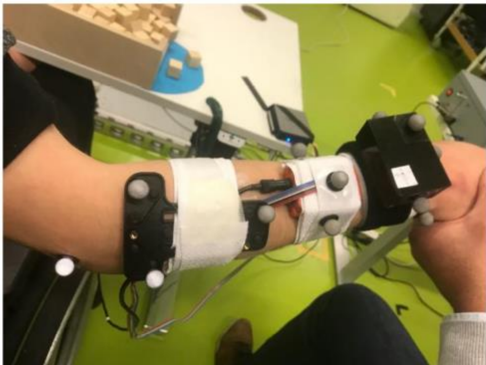
Figura 19. Posizionamento dell'unità IMU e dei marker utili per il MoCap
