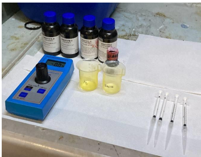
Figura 9 set up per la valutazione del rilascio di ioni argento Ag^+ in acqua
