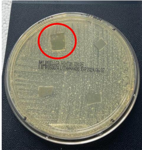
*Figura 28: Risultati del test dell'alone antibatterico dopo 48 ore di incubazione a 37 °C per il rivestimento al 60%wt a 200rps (cerchiato in rosso) che ha subito un trattamento al plasma.*
