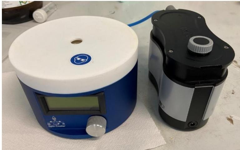
Figura 15: Spin coating a disposizione in laboratorio.
