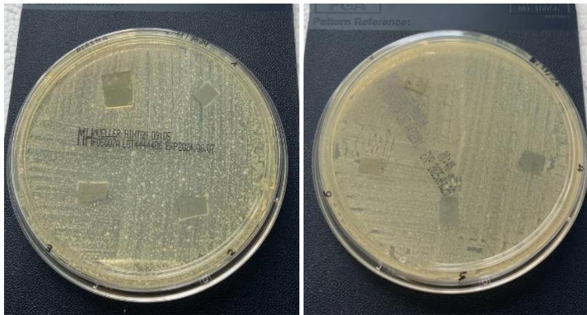
Figura 35: Risultati del test dell'alone antibatterico dopo 48 ore di incubazione a 37 °C per i rivestimenti composti da una matrice di Durazane in cui sono dispersi PVP e nSiO<sub>2</sub>-AgNPs (30%wt e 40%wt).
