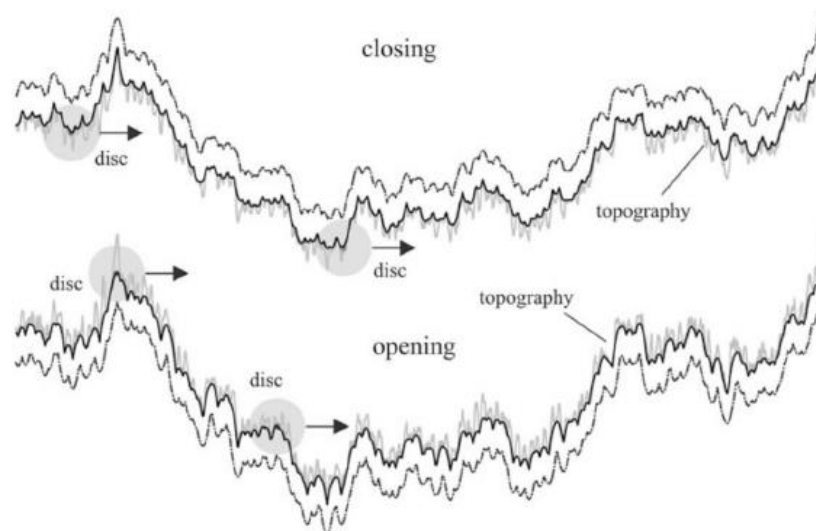
Figura 2.28 - Chiusura morfologica e apertura (disco come elemento strutturante) [34]
