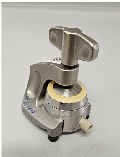
Figura 3.7: EL-Cell precedentemente assemblata.
