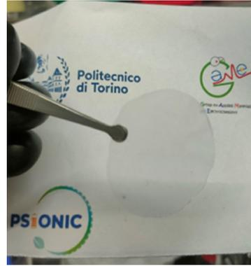
Figura 3.6: Membrana ottenuta al termine della pressatura a caldo [85].
