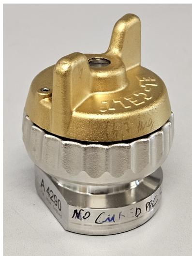
Figura 3.8: PAT-Cell precedentemente assemblata.
