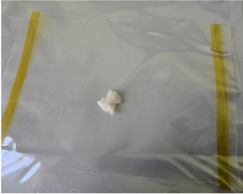
Figura 3.5: Formulazione prima della pressatura a caldo, posizionata tra due fogli di PP.
