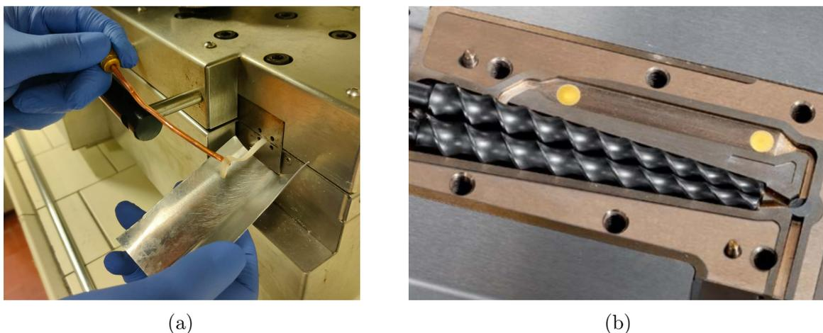
Figura 3.4: Immagini dell'estrusore utilizzato: a sinistra (a), estrazione della formulazione dopo il processo di omogeneizzazione [85] e a destra (b) l'interno dell'estrusore MHaake MiniLab II [90].
