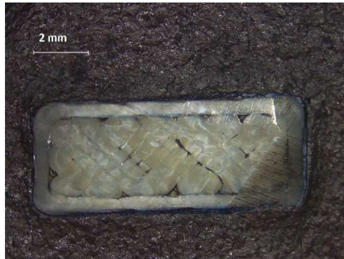
Figura 8.8: Provino in ULTEM™ 9085 rilevato in seguito a frattura con carico flessionale
