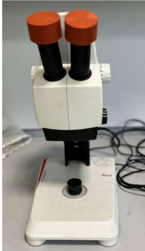
Figura 8.3: Immagine dello stereomicroscopio Leica EZ4W utilizzato per le analisi
