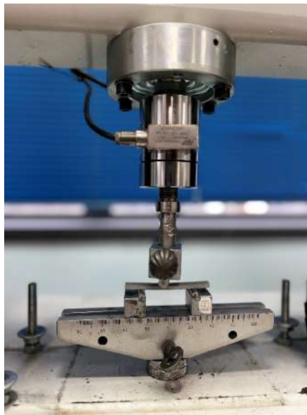
Figura 7.15: Test a flessione su provino in lega AlSi10Mg secondo lo standard ASTM D790
