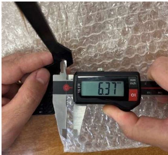
Figura 7.7: Misura delle tolleranze dimensionali del componente in sx) ULTEM™ 9085 e dx) ABS-M30™
