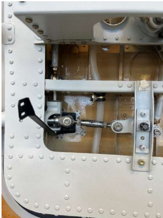
Figura 7.14: Verifica della funzionalità del support flag
