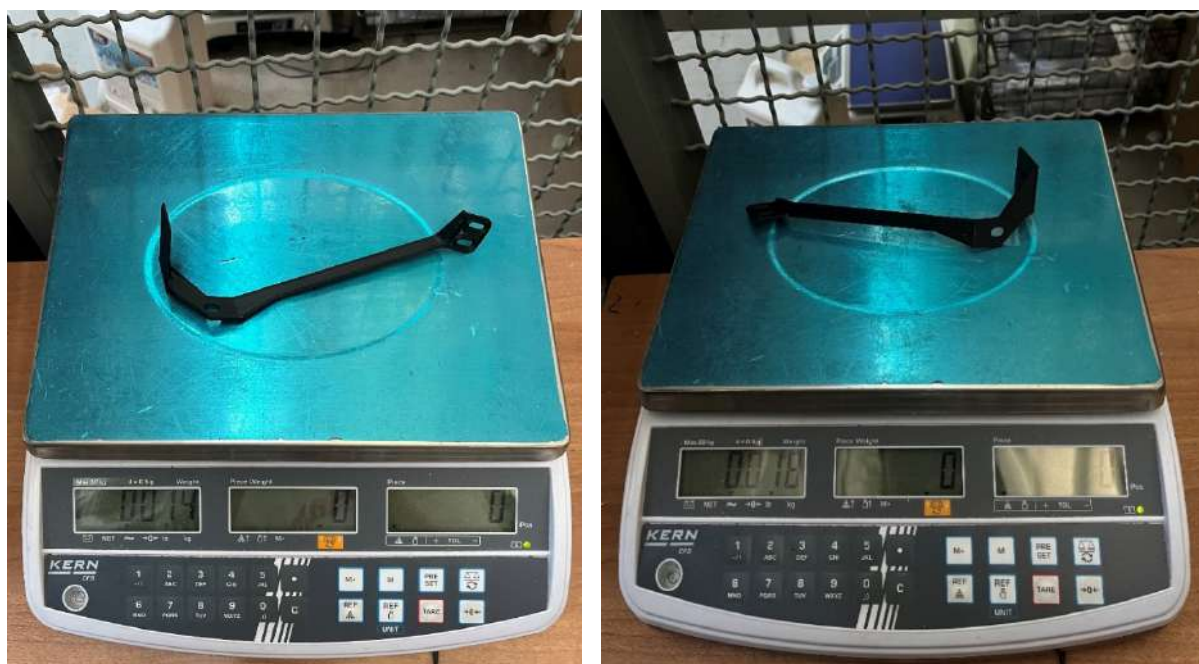
Figura 7.5: Misurazione del peso del componente con bilancia di precisione Kern CFS sx) in ABS-M30™ dx) ULTEM™ 9085
