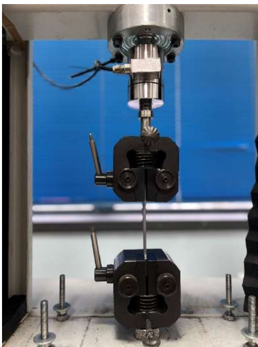
Figura 7.17: Test di trazione su provino in AlSi10Mg in Adler Aero
