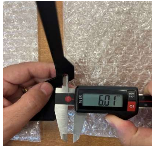
Figura 7.7: Misura delle tolleranze dimensionali del componente in sx) ULTEM™ 9085 e dx) ABS-M30™
