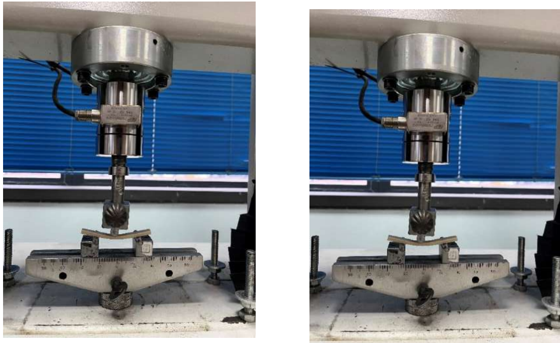
Figura 7.16: Test a flessione su provino in sx) ULTEM™ 9085 e dx) ABS-M30™ secondo lo standard ASTM D790
