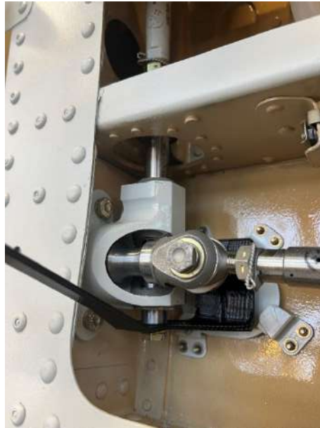
Figura 7.13: Inserimento del support flag con verifica delle condizioni di assemblaggio nel cargo door
