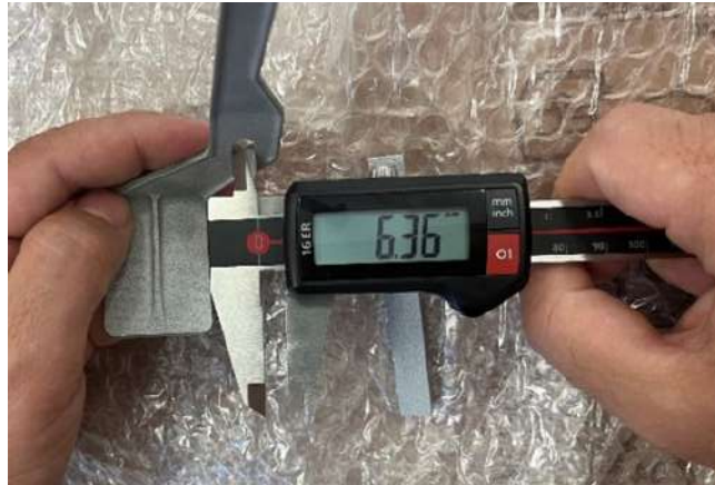
Figura 7.6: Verifica delle tolleranze dimensionali del support flag in AlSi10Mg
