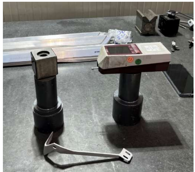
Figura 7.8sx): Rugosimetro SJ-210 sul componente in AlSi10Mg e dx) Sistema di supporto ad hoc per rilevazione della rugosità delle superfici oblique
