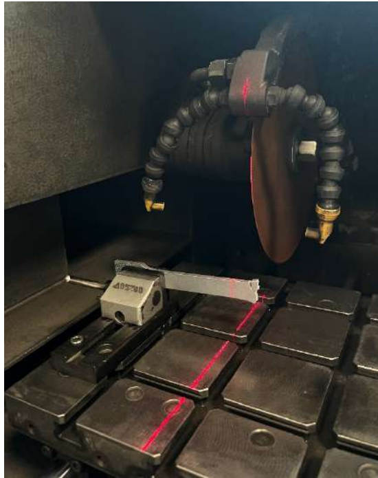
Figura 8.2: Fotografia interna del meccanismo di taglio con la macchina BRILLANT 220
