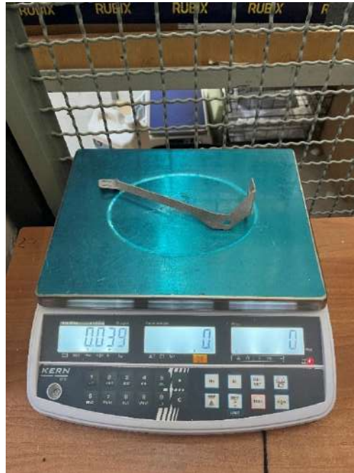
Figura 7.4: Misurazione del peso del componente in AlSi10Mg
