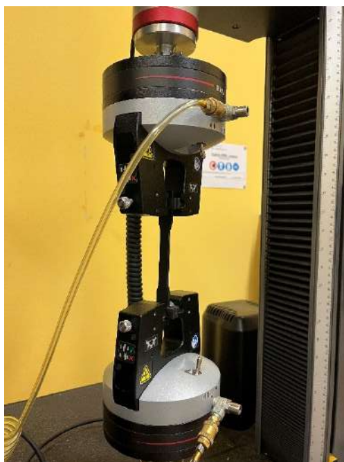
Figura 7.18: Test di trazione con afferraggi idraulici al laboratorio del Politecnico di Torino
