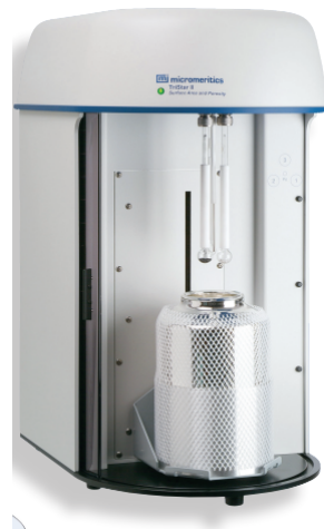
Figura 2.4: Strumento per l'analisi BET Micromeritics Tristar II 3020
