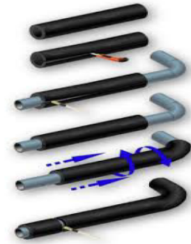
Figura 4.5: Rivestimento poliuretano di tubazioni [12].
