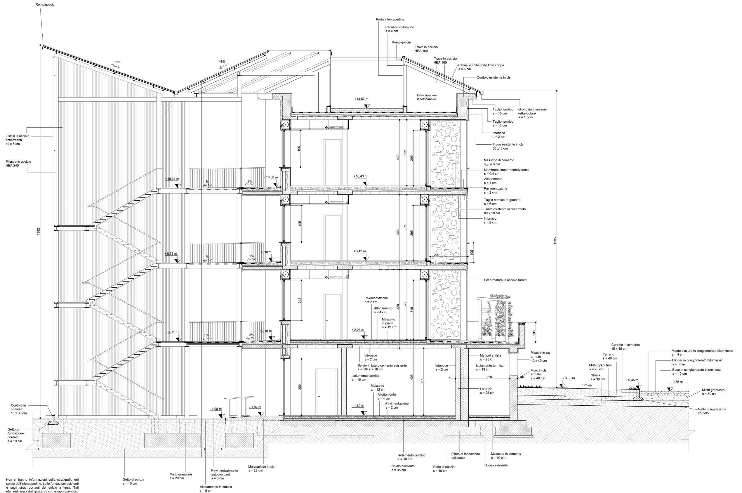
Non si hanno informazioni sulla stratigrafia del solaio dell'intercapedine, sulle fondazioni esistenti e sugli strati portanti del solaio a terra. Tali elementi sono stati ipotizzati come rappresentato.
