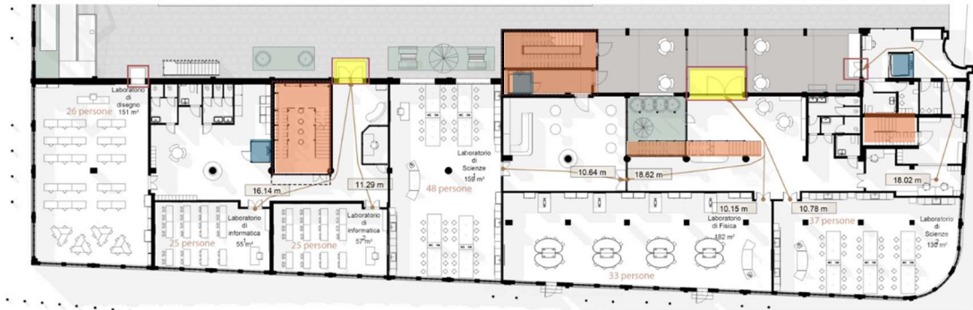
Figura 55- pianta con vani scala/ascensore evidenziati
