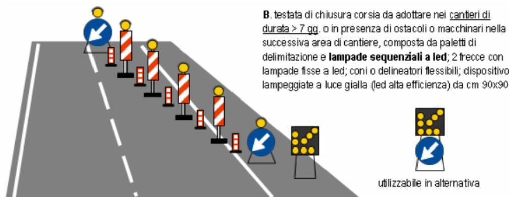
Figura 6.9: Esempio testata di chiusura di una corsia con l'uso di lampade sequenziali a led
