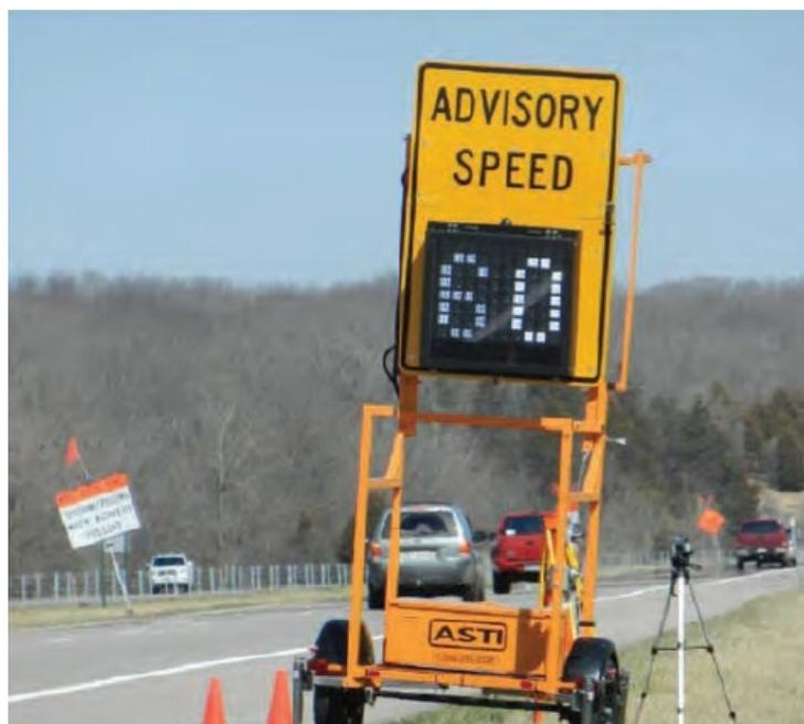
*Figura 6.6: limite di velocità portatile variabile*
