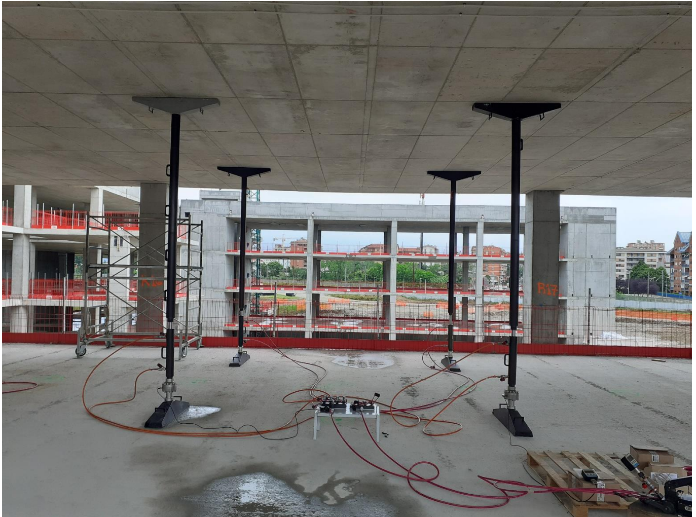
Figura 62. Prova_04: sistema di applicazione del carico con martinetto oleodinamici
