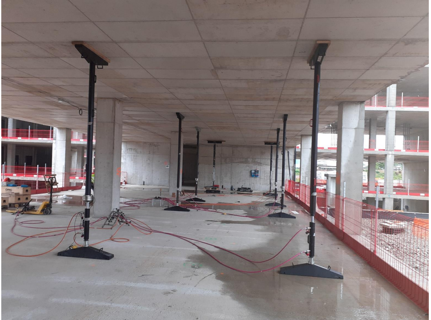
Figura 58. Prova_02: sistema di applicazione del carico con martinetto oleodinamici
