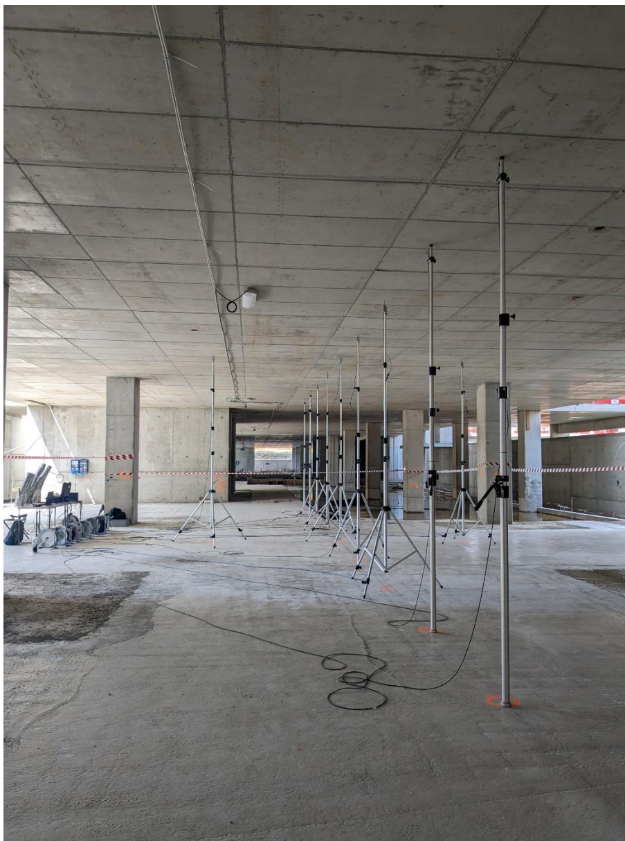
Figura 59. Prova_03: misura degli abbassamenti con n.11 trasduttori di spostamento installati su aste telescopiche
