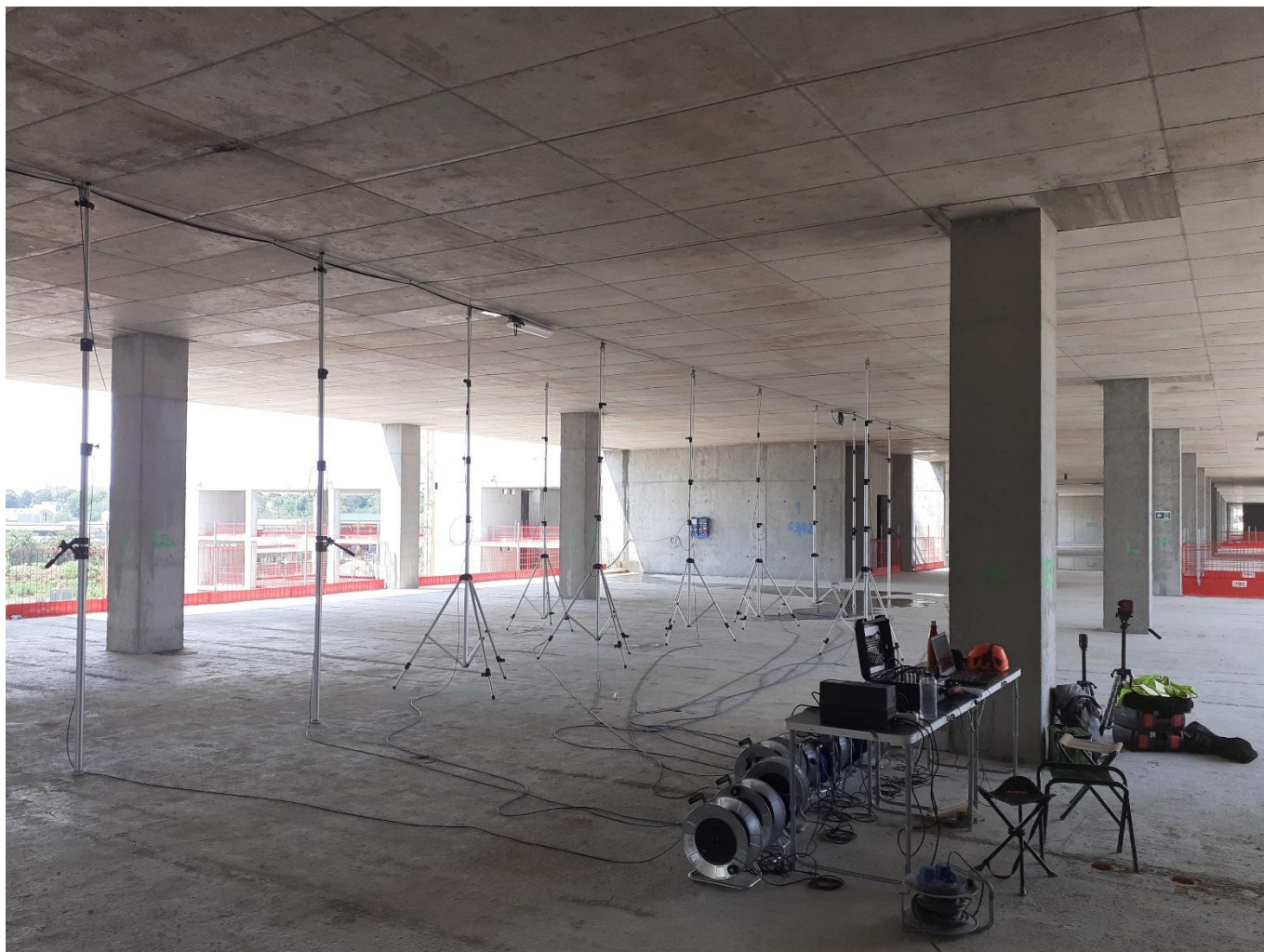
Figura 65. Prova_06: misura degli abbassamenti con n.11 trasduttori di spostamento installati su aste telescopiche
