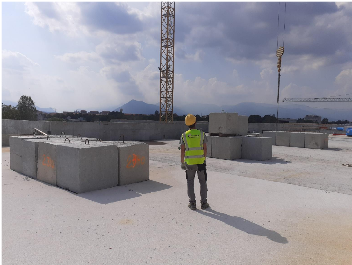
Figura 66. Prova_06: blocchi di calcestruzzo posizionati sui tre campi di solaio oggetto di prova
