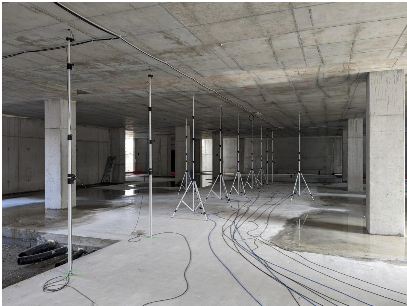
Figura 55. Prova_01: misura degli abbassamenti con n.11 trasduttori di spostamento installati su aste telescopiche
