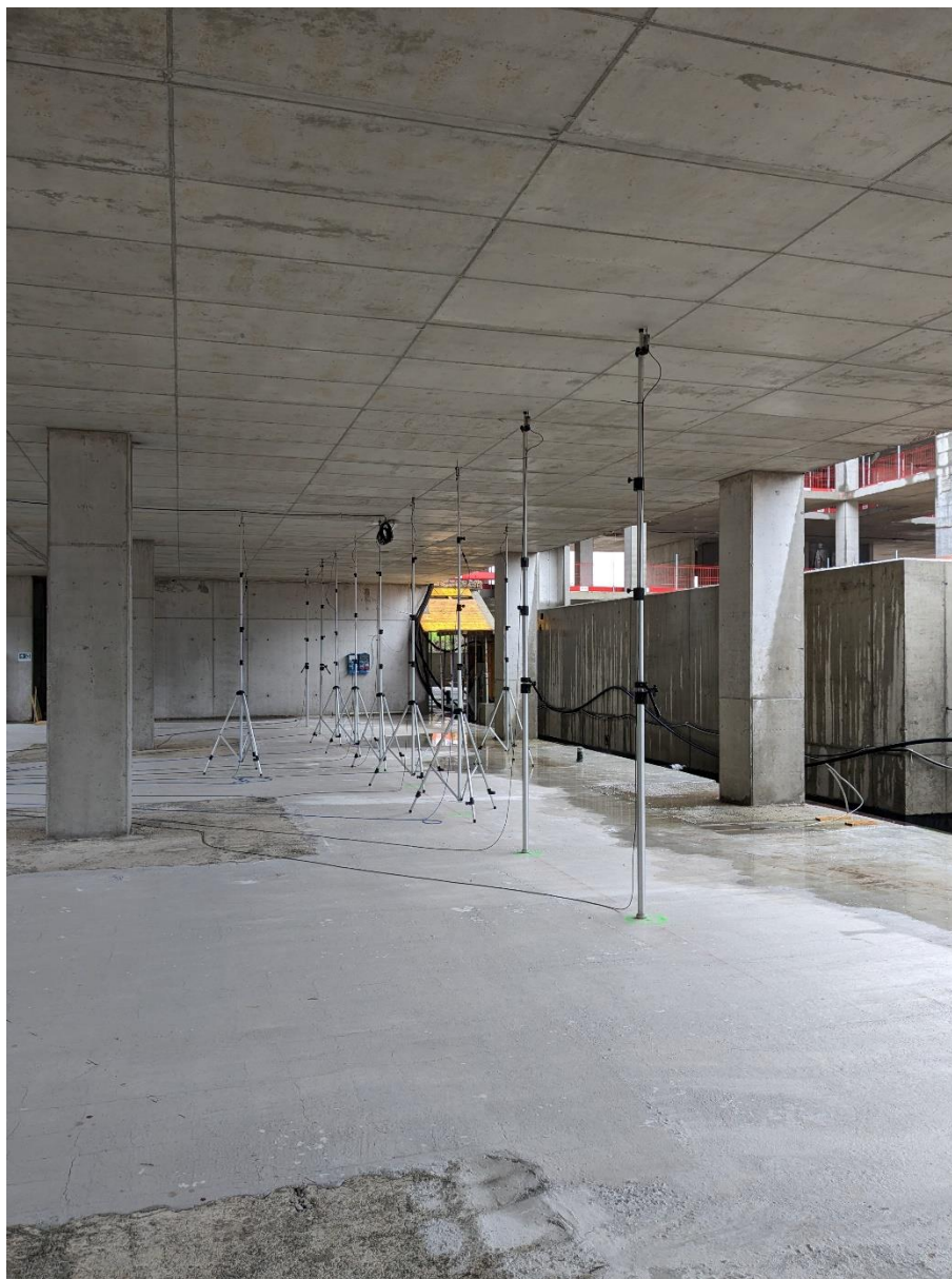
Figura 57. Prova_02: misura degli abbassamenti con n.11 trasduttori di spostamento installati su aste telescopiche
