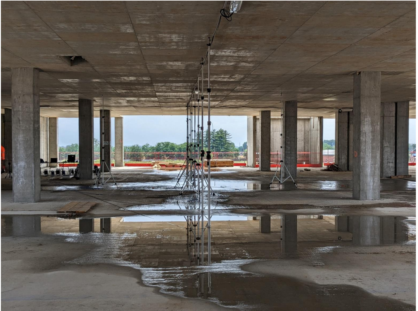
Figura 63. Prova_05: misura degli abbassamenti con n.11 trasduttori di spostamento installati su aste telescopiche
