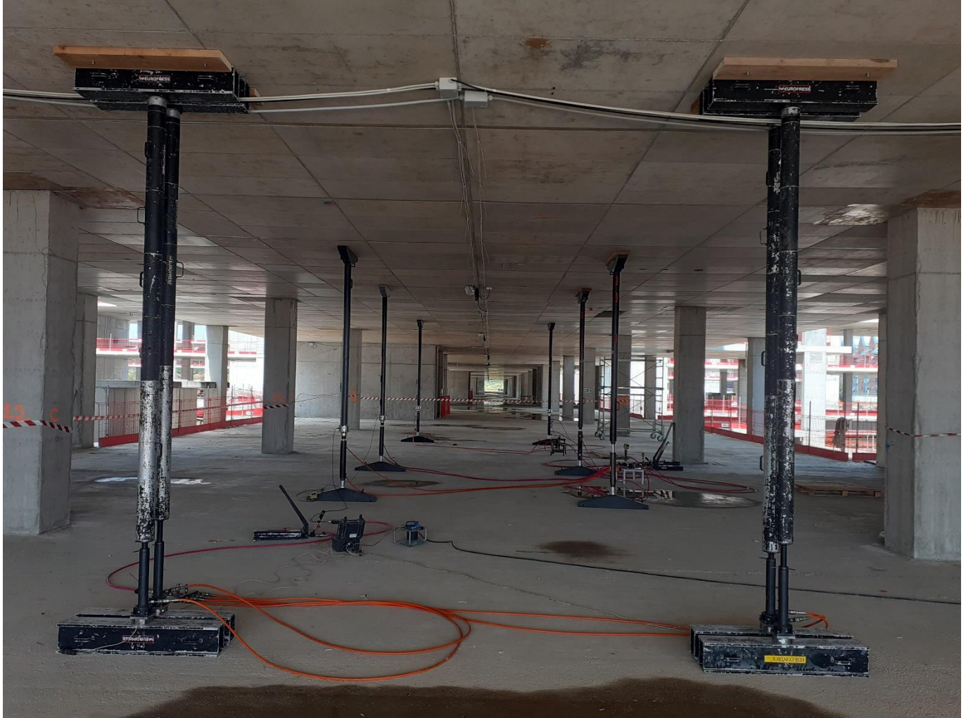
Figura 56. Prova_01: sistema di applicazione del carico con martinetti oleodinamici
