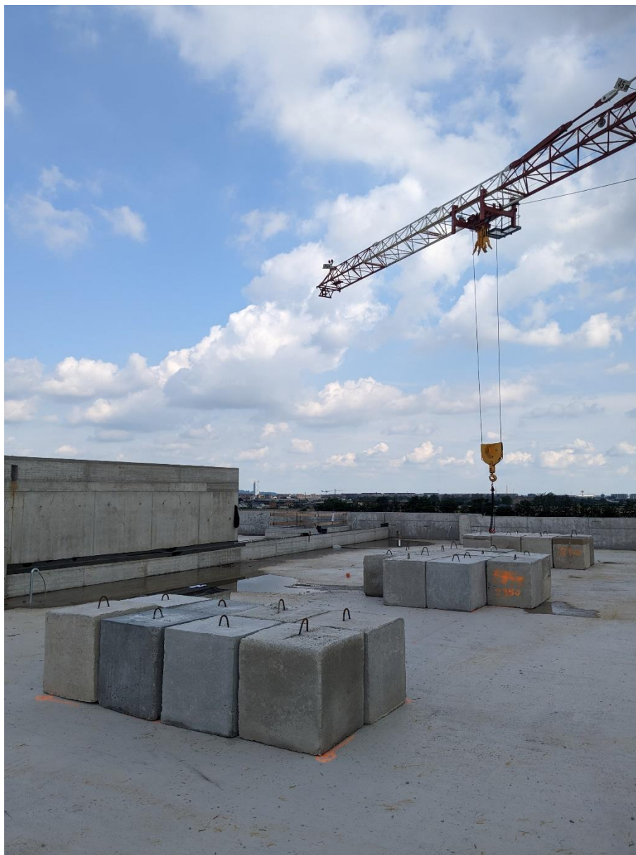
Figura 64. Prova_05: blocchi di calcestruzzo posizionati sui tre campi di solaio oggetto di prova
