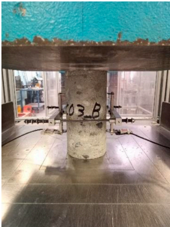
Figura 34. Carote estratte sottoposte a prova di compressione
