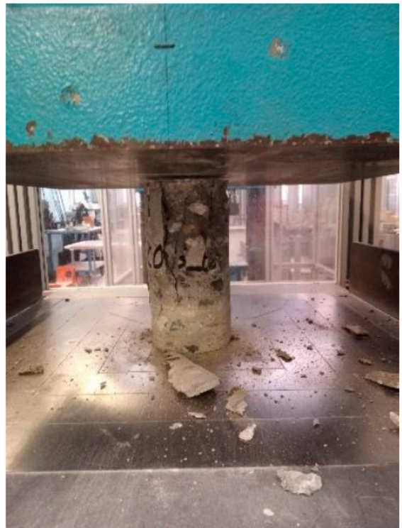
Figura 34. Carote estratte sottoposte a prova di compressione
