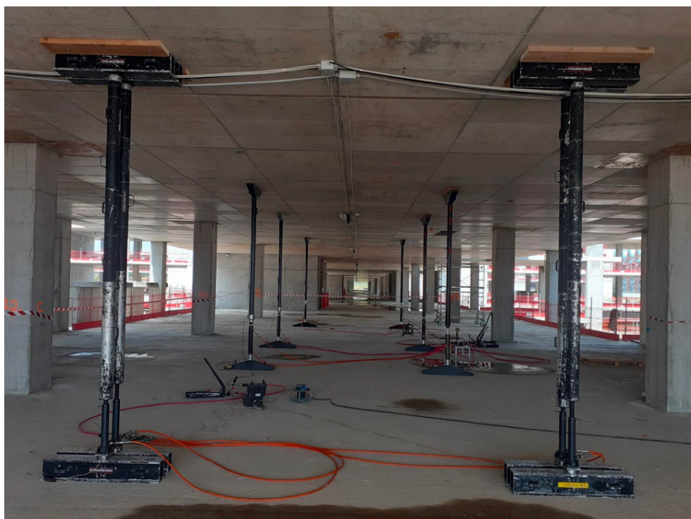
Figura 29. Martinetti oleodinamici per sistema di applicazione del carico
