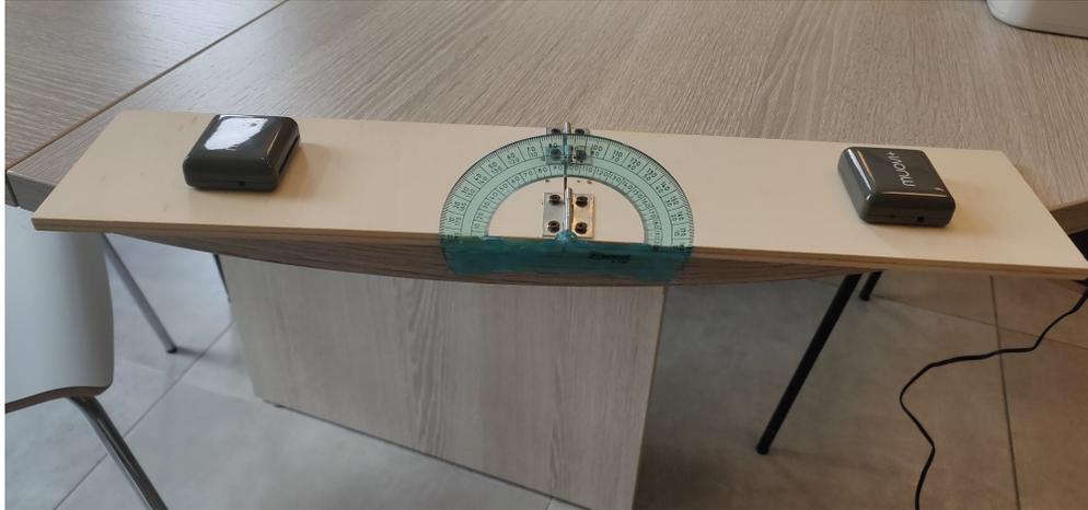
**Figura 6.1:** *Sistema meccanico utilizzato per la validazione composto da una tavola di legno con cerniera e goniometro.*
