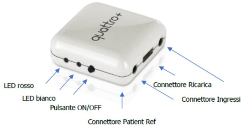
**Figura 2.4:** *Illustrazione della componentistica hardware del Quattro+, che include: il connettore ingressi della sonda, connettore ricarica della sonda, vari LED indicatori dello stato operativo, il pulsante di accensione/spengimento (ON/OFF) e il connettore per il riferimento del paziente (patient Ref).*
