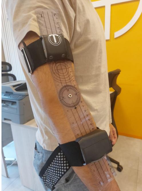
**Figura 1.4:** *Sistema di validazione per il gomito composto da 2 sonde IMU e goniometro articolare.*
