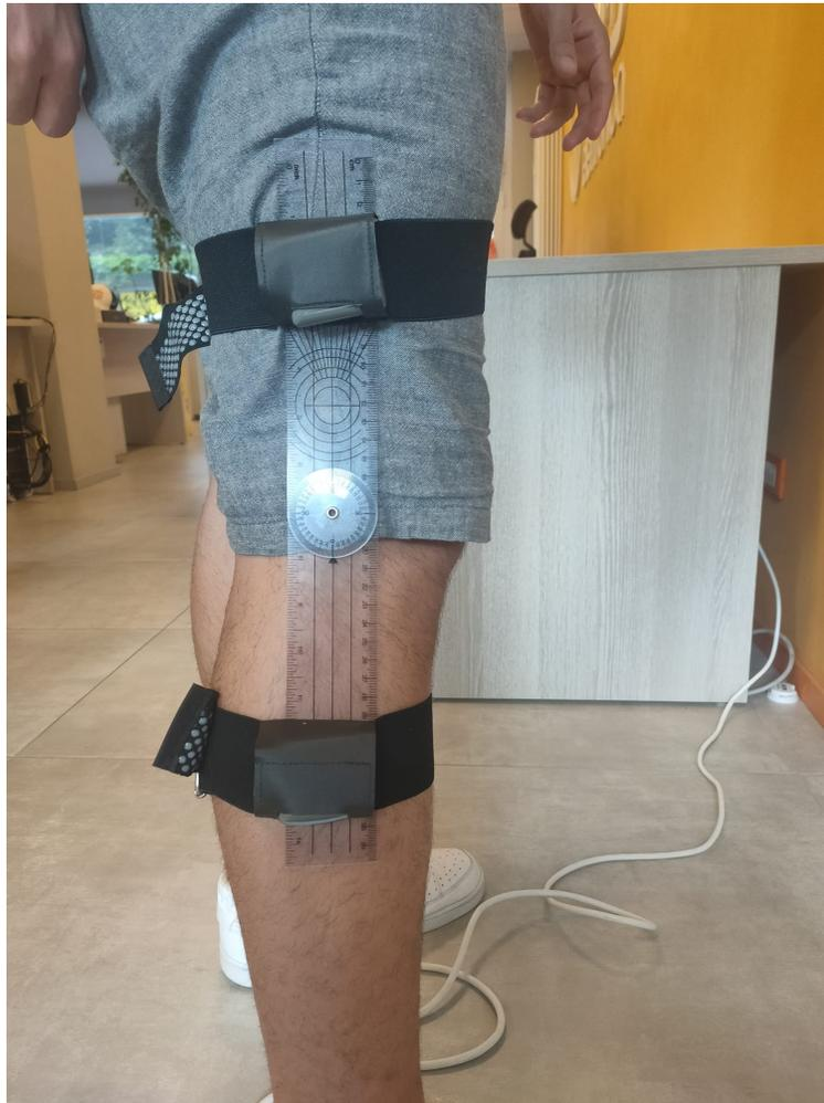
**Figura 6.2:** *Sistema di validazione per il ginocchio composto da 2 sonde IMU e goniometro articolare.*
