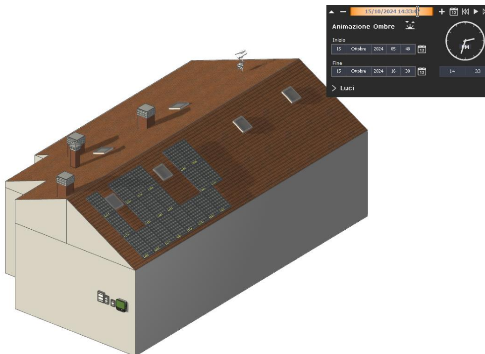
FIGURA 66: OMBRE SUI MODULI FOTOVOLTAICI ALLE 14:33 DEL 15 OTTOBRE
