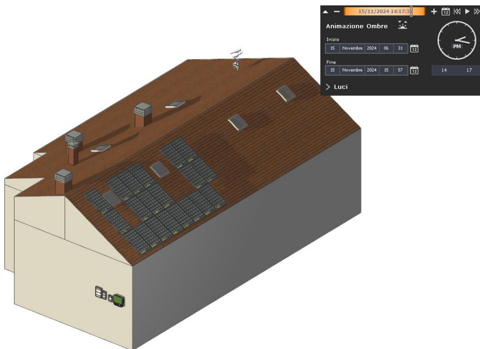
FIGURA 67: OMBRE SUI MODULI FOTOVOLTAICI ALLE 14:17 DEL 15 NOVEMBRE
