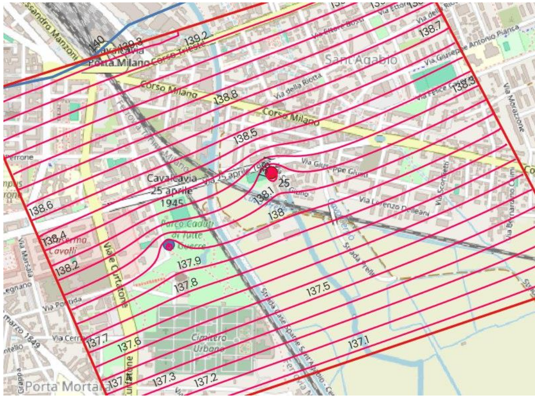
Figura 42a: Condizione dinamica del livello piezometrico a seguito della captazione di entrambi i pozzi
