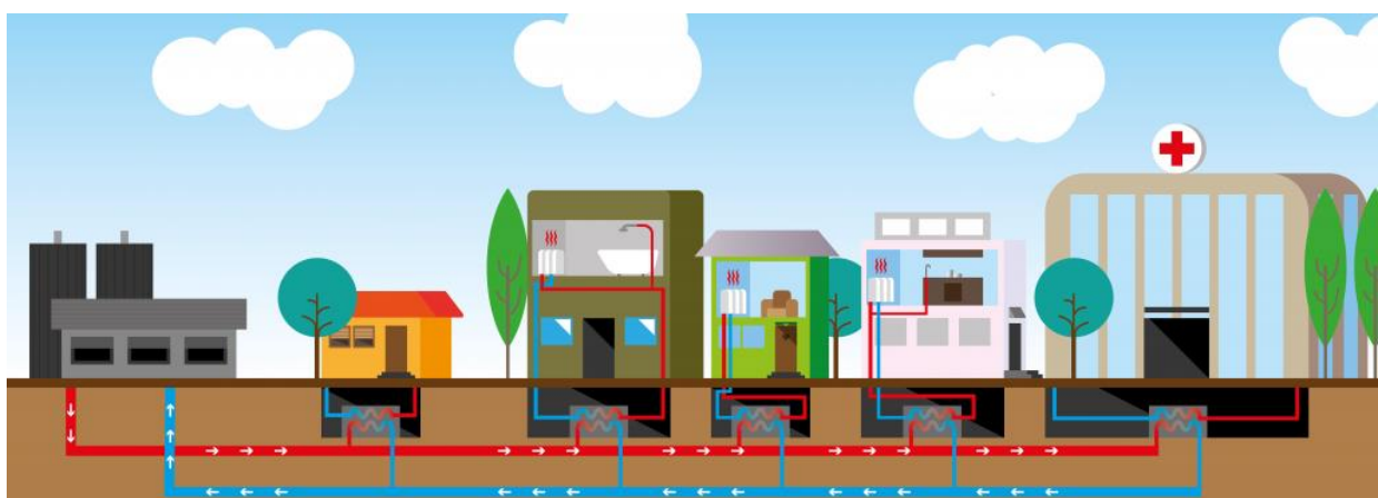
Figura 3: Rappresentazione concettuale di una rete di teleriscaldamento
