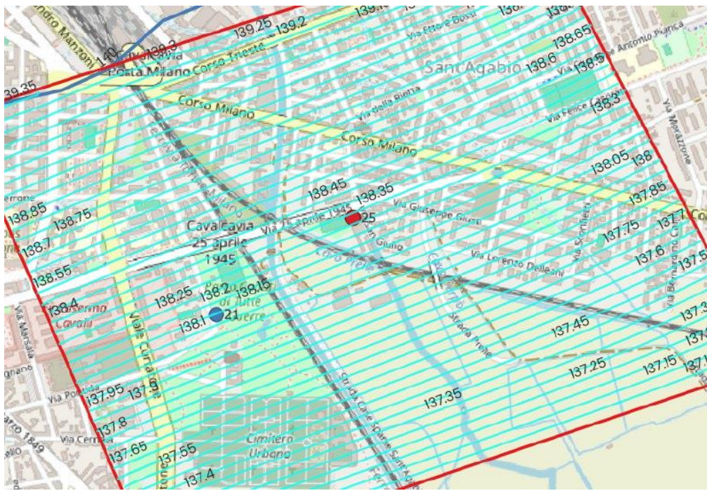
Figura 39: Condizione statica iniziale del flusso d'acqua sotterraneo
