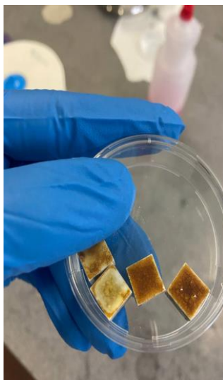
Figura 10: deposizione a goccia di soluzione AgNPs sintetizzate in una soluzione acquosa con TA + Durazane su pezzi di allumina e lasciati in forno a 400° C per 24h
