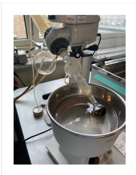
Figura 15: utilizzo di acqua e bollitore per riscaldare e mantenere a T costante il palloncino
