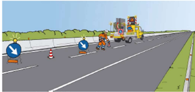
Figura 16_ Chiusura della corsia di sorpasso: Inizio della posa dei segnali complementari (coni, delineatori flessibili, ecc...) per la delimitazione longitudinale dell'area di cantiere o per la separazione dei due flussi veicolari contrapposti
