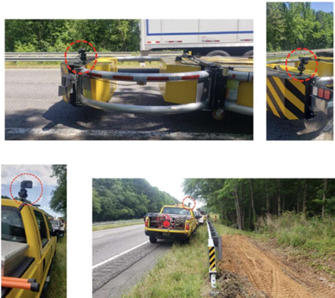
Figura 131_ Installazione del dispositivo di cattura delle immagini (cellulare) sui mezzi di servizio
