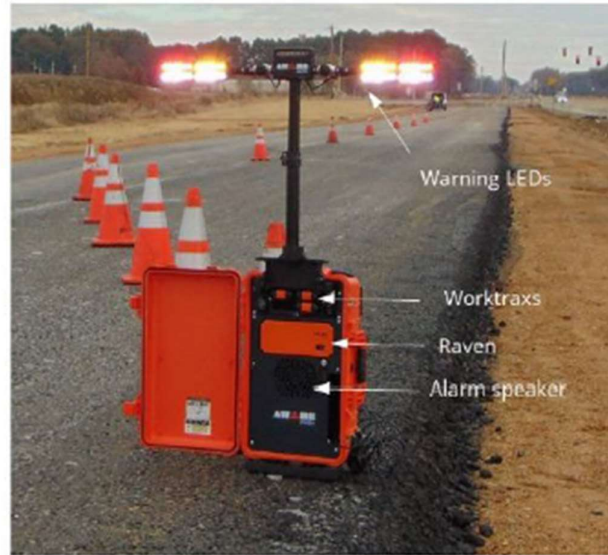
Figura 62_componenti del sistema in configurazione AWARE Sentry
