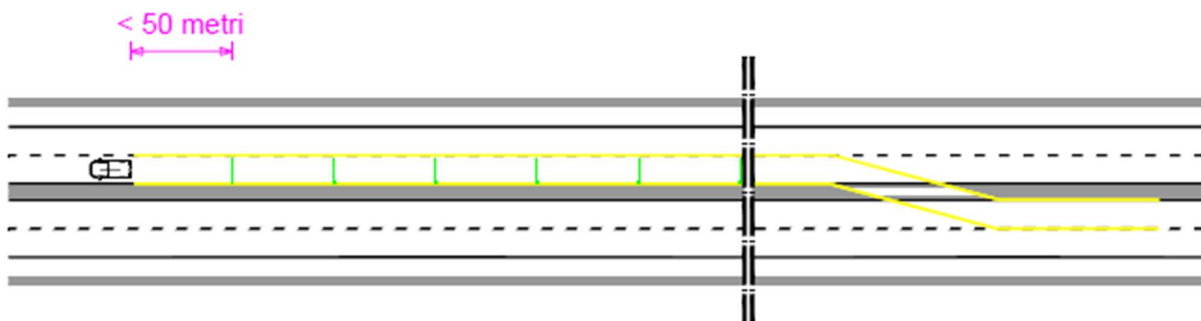
Figura 137_ Installazione del dispositivo Single Sentry Beam _ Laser orientato in direzione perpendicolare rispetto al flusso veicolare
