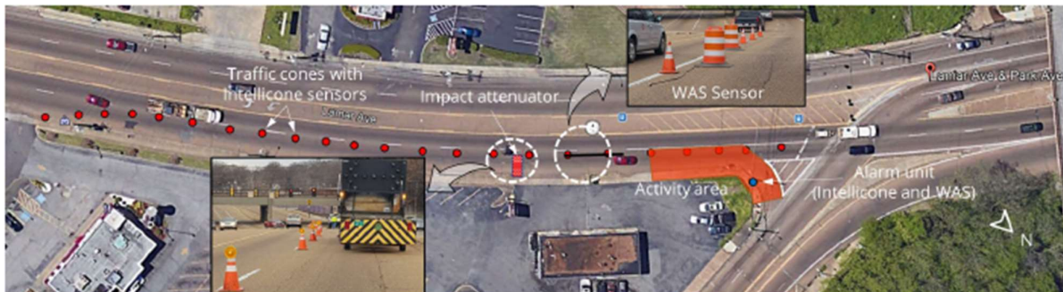
Figura 106_Installazione nell'area di cantiere dei sistemi Intellicone e WAS _ Terza configurazione di cantiere
