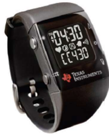
Figura 76_ Orologio programmabile scelto come dispositivo di allarme personale
