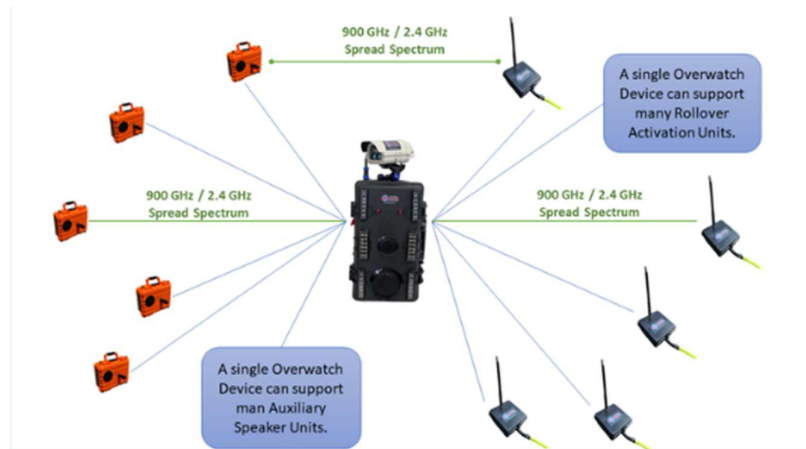
Figura 72_Raffigurazione della capacità del dispositivo di comunicare contemporaneamente con molteplici accessori
