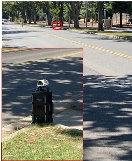
Figura 98_Installazione del dispositivo Alpha SafeNet Portable Overwatch Device per le prove in condizioni controllate
