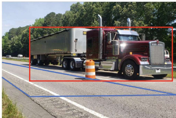
Figura 132_Condizione di innesco involontario _ Problematica legata al funzionamento dell'algoritmo e della cattura delle immagini
