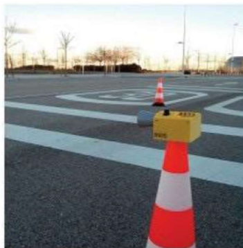
Figura 74_Installazione del Sensor Node su un cono stradale standard
