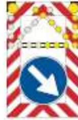
Figura II 401 Art. 39 SEGNALE MOBILE DI PROTEZIONE
