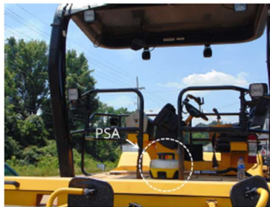
Figura 108_Dispositivi di allarme collettivo (PSA) installato sul rullo compattatore
