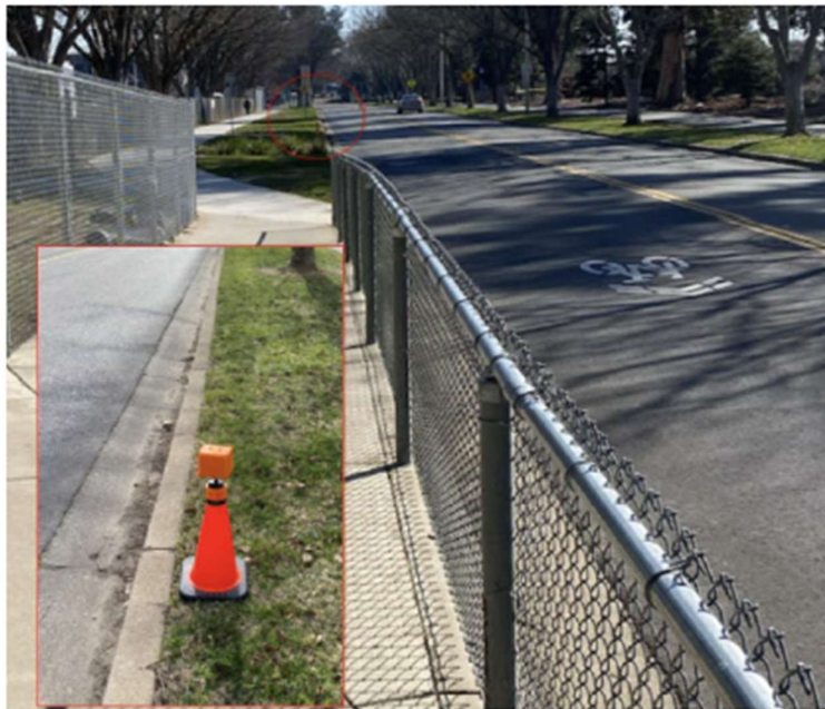
Figura 97_Installazione del dispositivo Guardian Cone per le prove in condizioni controllate
