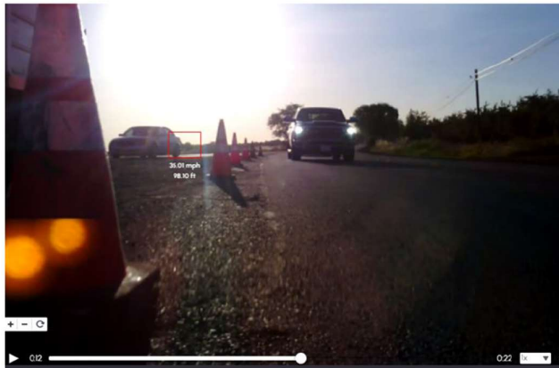
Figura 122_Individuazione di un veicolo nella strada divergente a monte del dispositivo AWARE Sentry _ Attivazione del dispositivo e falso allarme
