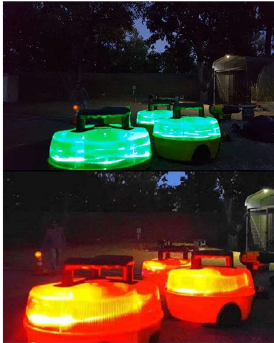
Figura 55_Allarme luminoso del PSA_ immagine tratta dal report "Evaluation of Work Zone Intrusion Alarms" (31)
