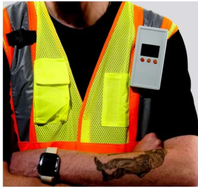
Figura 65_Ricevitore personale indossato sul gilet da cantiere
