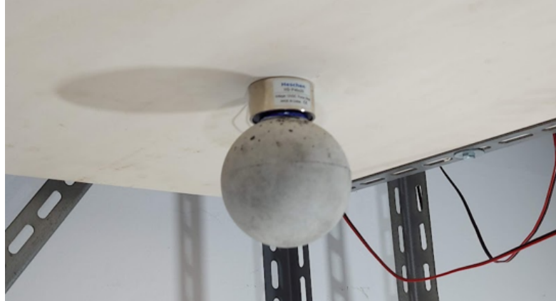
Figura 6.2: Dettaglio del provino in posizione iniziale sotto l'elettromagnete
