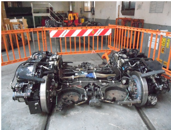
Figura 2.10: Carrello tranviario moderno a pianale ribassato
