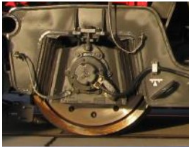
Figura 2.13: Sospensione con blocchi in gomma
