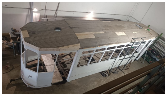
Figura 5.8: Cassa della motrice 614 in fase di restauro
