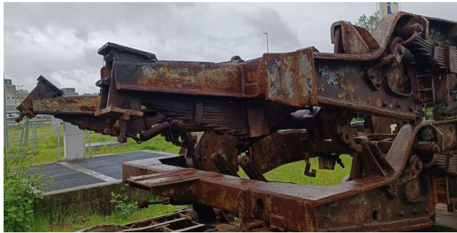
Figura 5.7: Sospensioni secondarie a balestra utilizzate per il restauro
