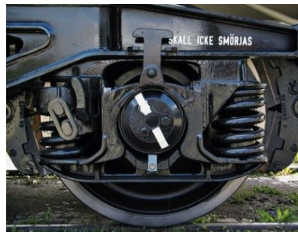
Figura 2.12: Sospensione primaria a molle elicoidali, con guida boccola a cappello di carabinieri
