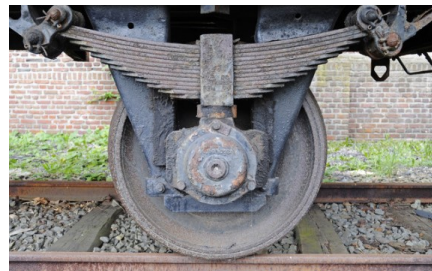
Figura 2.11: Sospensione primaria a balestra, completa di parasale
