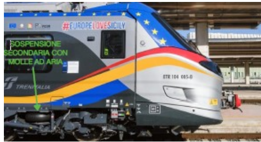
Figura 2.15: Sospensioni secondarie con molle ad aria del treno ETR 104 (POP)
