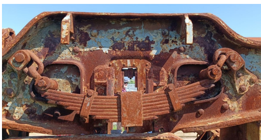
Figura 5.6: Sospensioni primarie a balestra utilizzate per il restauro fissa mentre le estremità si piegano.
