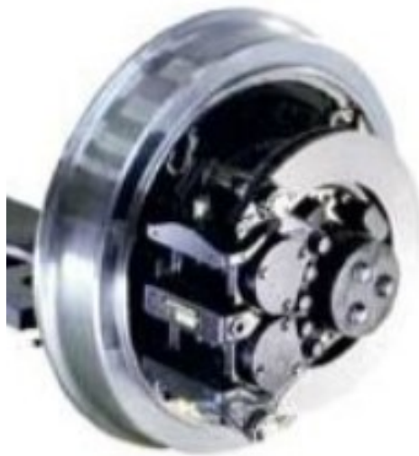
Figura 2.23: Freno a disco tranviario montato direttamente sul fusello
