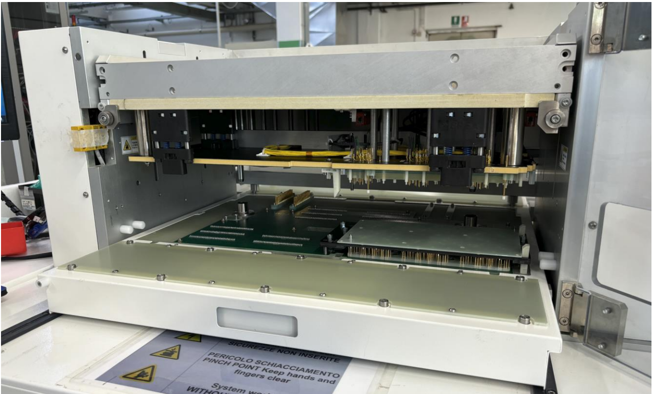
Figura 5.7: fixture in macchina di test manuale per il debug
