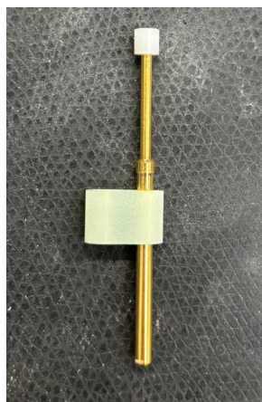
Figura 1.11: blocchetto chiodo spintore per precentraggio scheda sul bottom fixture
