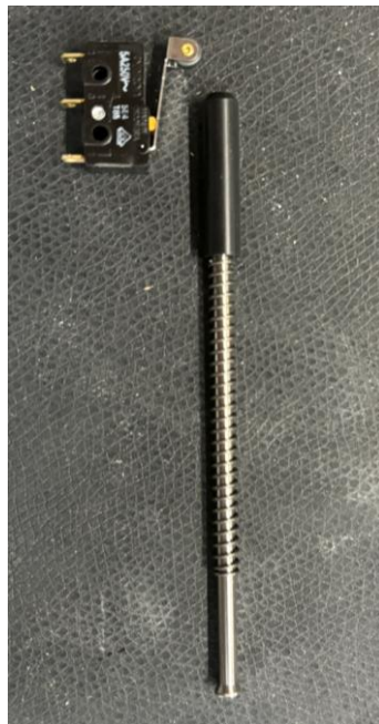
Figura 1.16: sensore anticollisione per verifica corretto inserimento scheda in fixture
