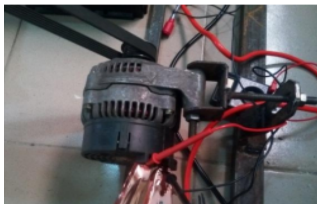
Figura 21 Generatore elettrico collegato tramite cinghia al volano (Okoye, 2021)
