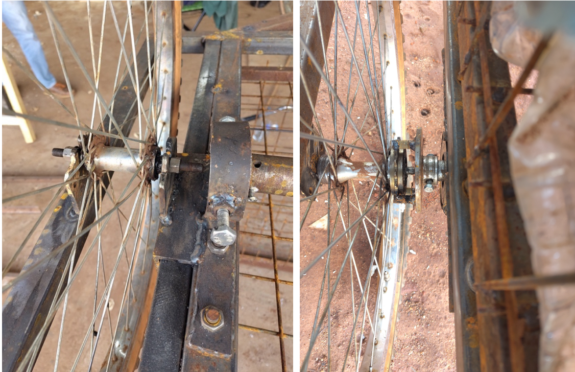
Figura 53 a sinistra dettaglio della ruota libera, a destra dettaglio della ruota collegata all'albero (Baiskeli Uganda, 2024)
