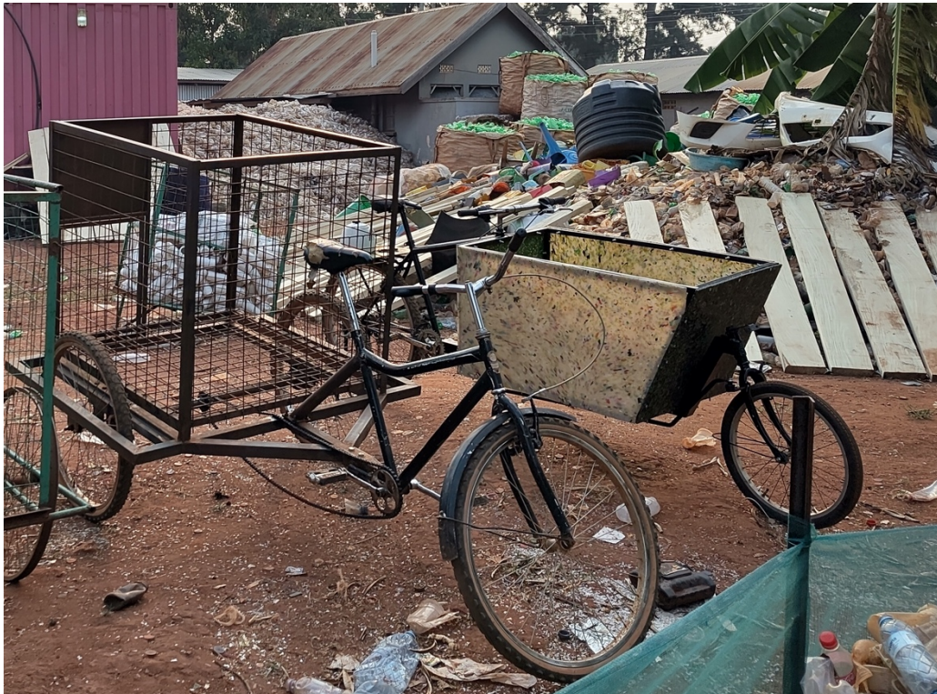
Figura 51 Secondo prototipo realizzato da takataka, di tipo Rear loader (Baiskeli Uganda, 2024)
