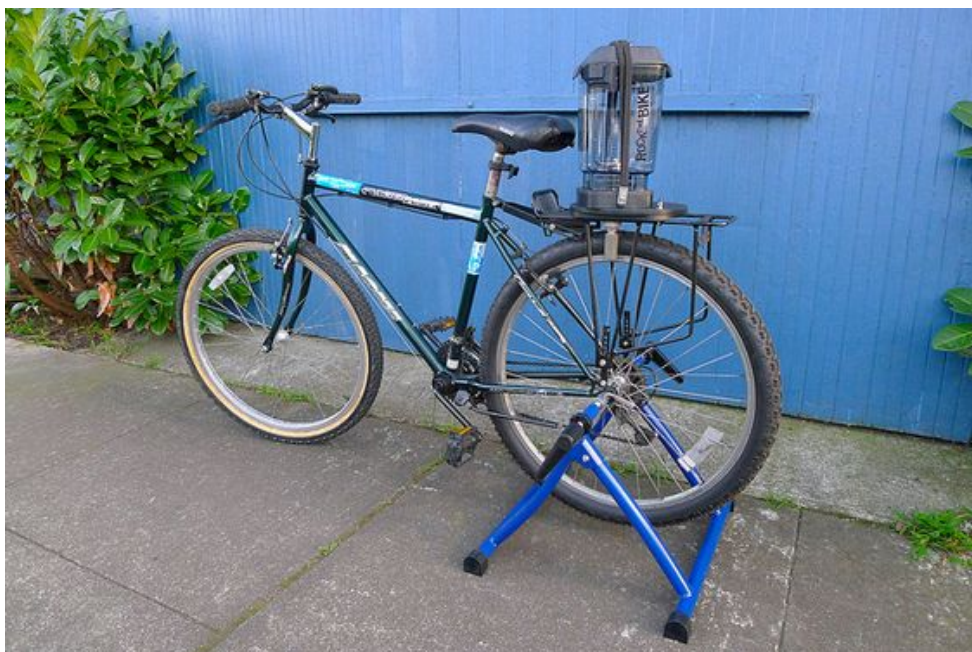
Figura 23 Esempio di frullatore attuato tramite sistema modulare montato su una bicicletta
