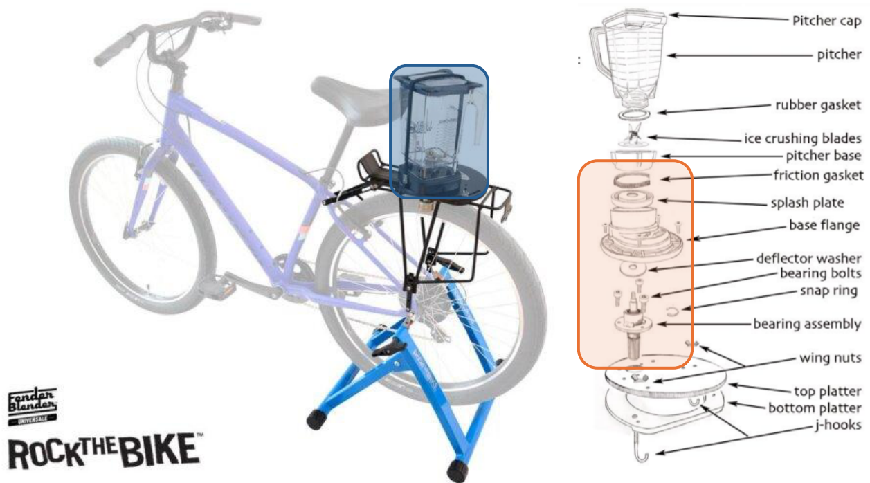
Figura 26 a sx il prodotto Fender Blender Universale montato su una bicicletta, a dx esploso del meccanismo di trasmissione e del frullatore (Rock the Bike, 2024)
