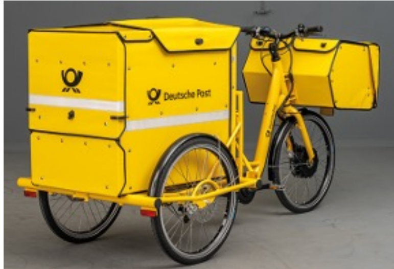
Figura 36 Triciclo cargo in configurazione "delta" utilizzato per last-mile delivery
