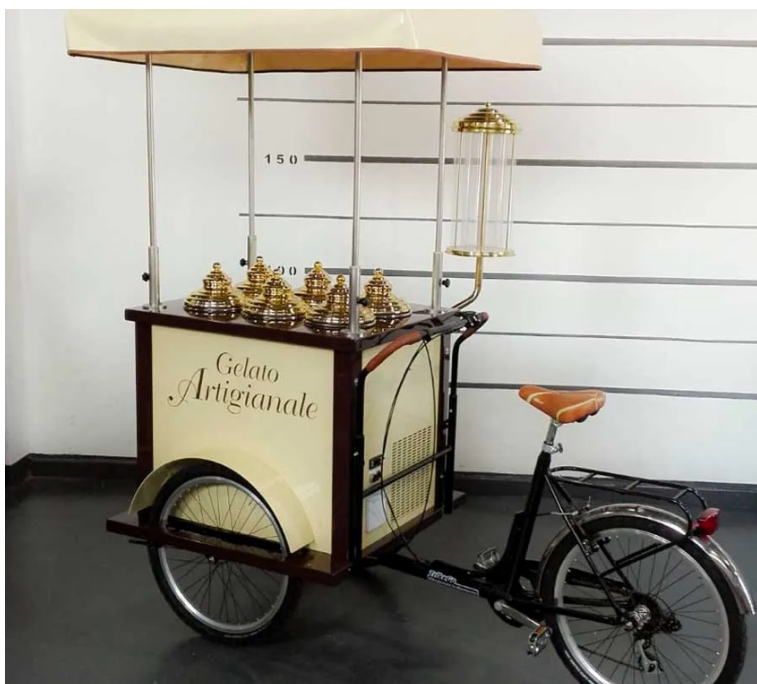
Figura 34 Triciclo cargo in configurazione "tadpole" utilizzato per attività commerciale
