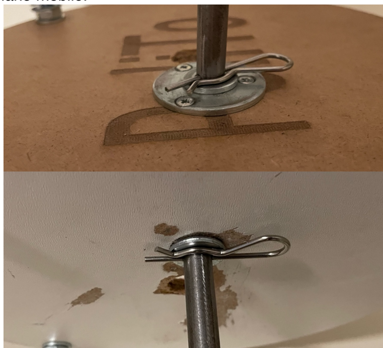
Figura 98 Sistema di sgancio dell'albero di trasmissione: In alto copiglia di fissaggio superiore, in basso copiglia inferiore
