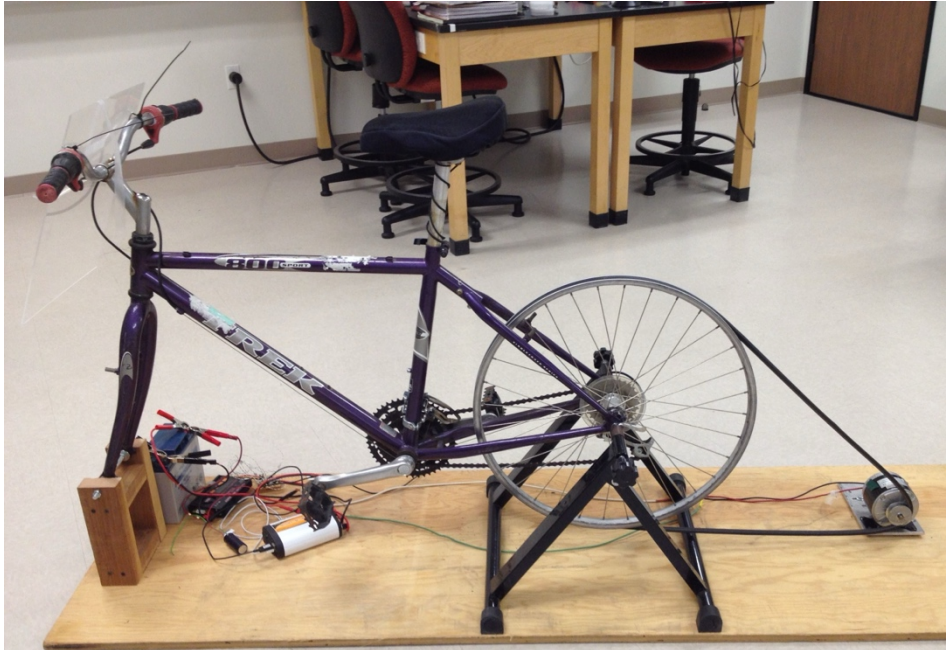
Figura 22 Esempio di mezzo a pedali con sistema elettrico stazionario per alimentare dispositivi
