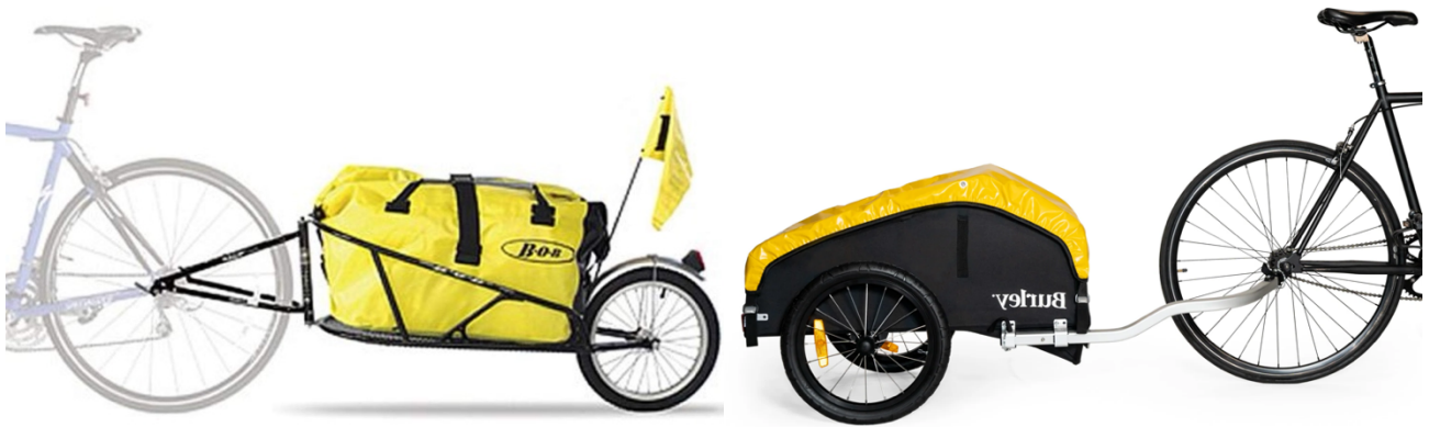
Figura 39 a sinistra trailer cargo ad una ruota, a destra trailer cargo a due ruote
