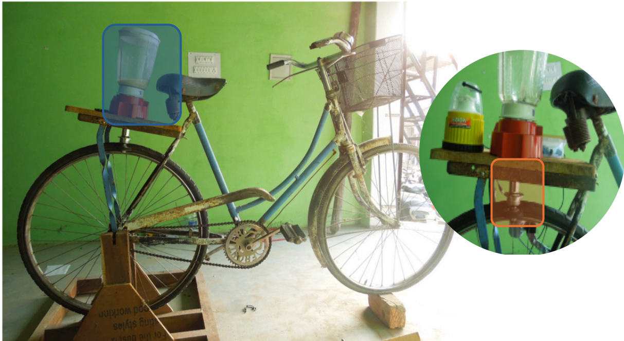
Figura 28 a sx prototipo con frullatore a contatto a contatto con la ruota posteriore, a dx particolare del meccanismo a frizione (Bijli bicycle, 2016)
