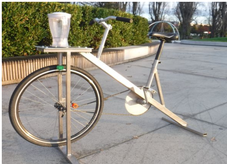
Figura 20 Esempio di frullatore attuato da mezzo a pedali tramite sistema meccanico stazionario
