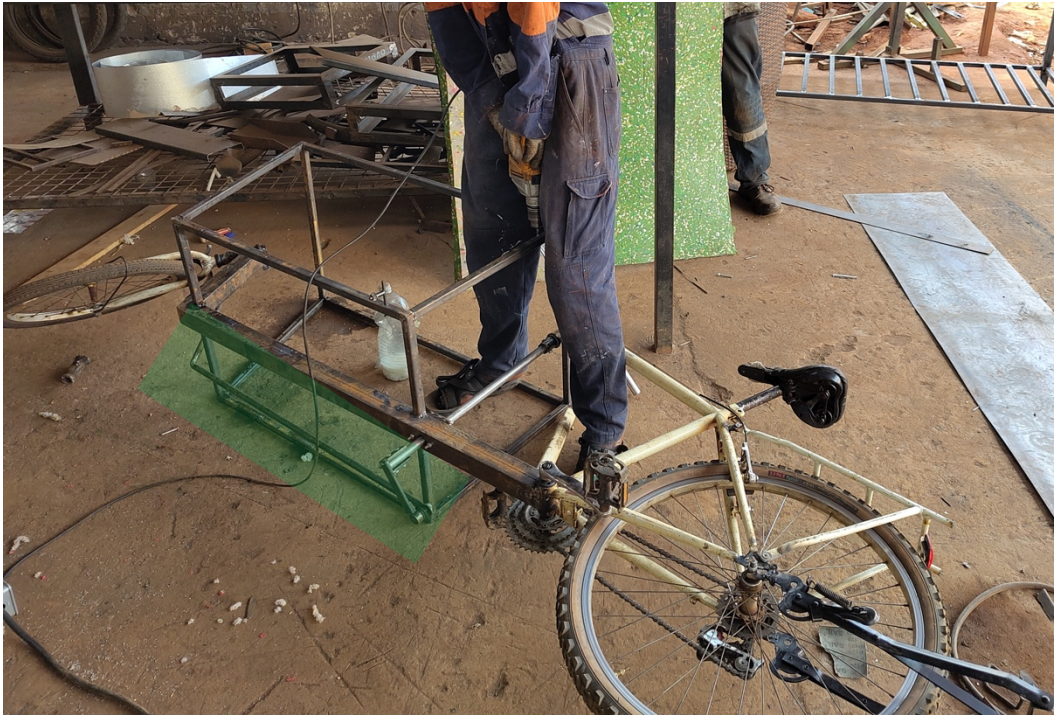
Figura 50 Dettaglio del leveraggio collegato al tubo di sterzo e del telaio del box cargo (Baiskeli Uganda, 2024)
