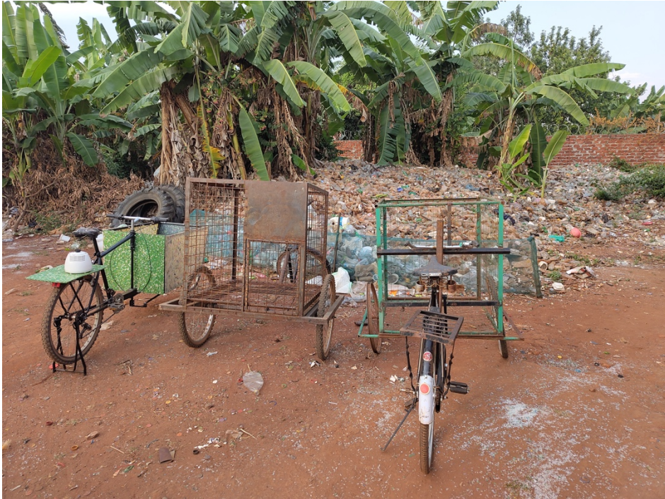
Figura 16 Prototipi di mezzi cargo realizzati da Takataka: a sinistra il prototipo di bicicletta con frullatore integrato e box cargo all'anteriore (Baiskeli Uganda, 2024)
