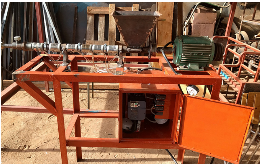
Figura 14 Macchinario di estrusione realizzato da Takataka in collaborazione con l'Università di Gulu, utilizzato per fondere la plastica triturata (TakaTaka Plastics, 2024)
