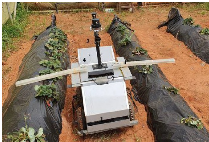
Figura 1.7: Robot per il trattamento delle piante tramite irrorazione: Agri-Eco robot [17]
