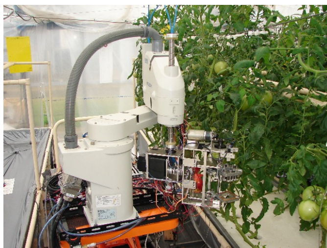
Figura 1.4: End-effector per la raccolta dei pomodori [13]
