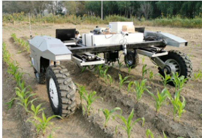
Figura 1.1: Sistema robotico intelligente di diserbo meccanico su fila [7], [9]
