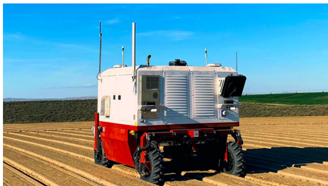
Figura 1.2: Robot per il controllo delle infestanti con tecnologia laser [10],[11]
