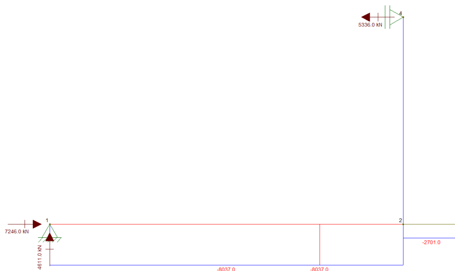
Figura 46 Sforzo normale sul braccio
