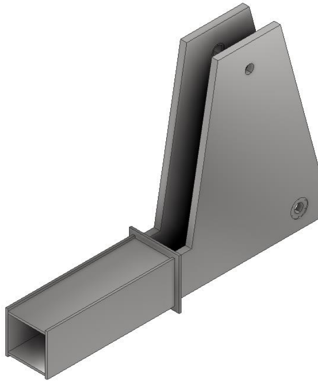
Figura 43 Dettaglio della sezione dello scatolato
