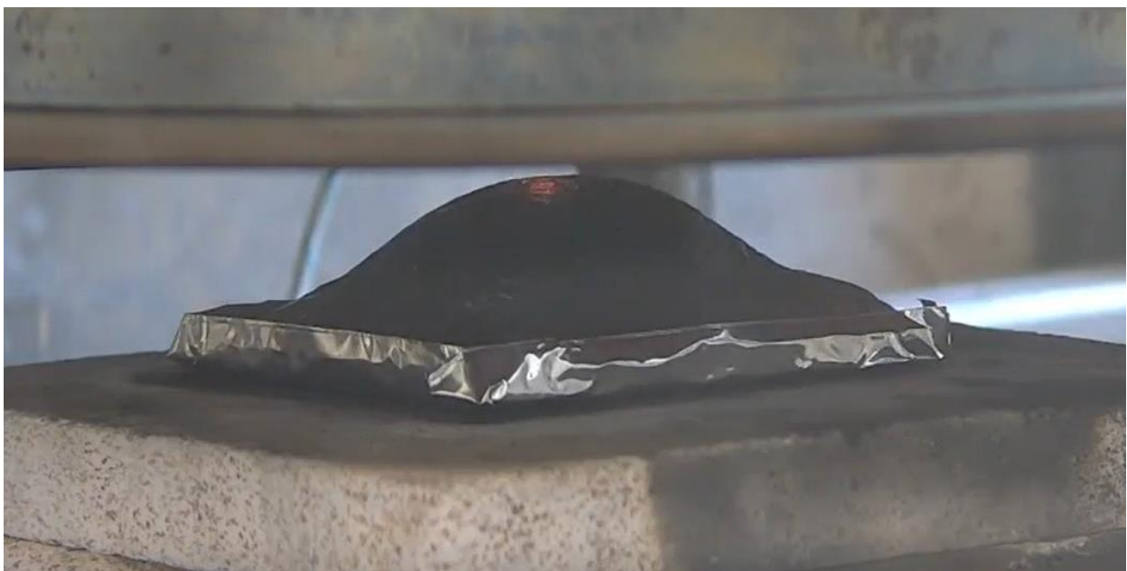
Figura 4.2 Rigonfiamento del campione EVA5I3F 2, in primo piano la barriera protettiva
