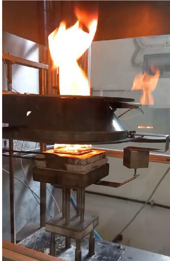
Figura 2.23 campione di materiale polimerico che brucia durante un test al cono calorimetrico a consumo di ossigeno.
