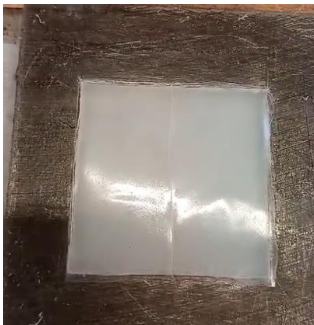
Figura 3.14 Esempio di preparazione dei provini rivestiti, i due tratti di nastro affiancati vengono appoggiati sulla base di matrice, segue lo stampaggio.
