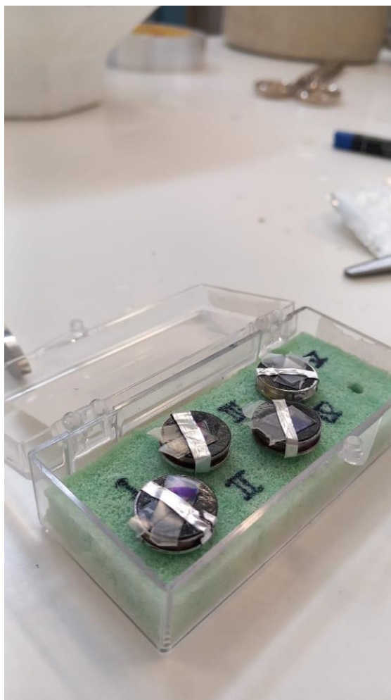
Figura 3.18 campioni preparati per l'analisi al SEM
