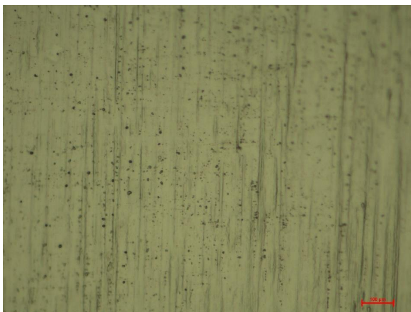
Figura 4.30 Immagine ricavata al microscopio ottico con ingrandimento 50X di film EVA+5% MgAl F
