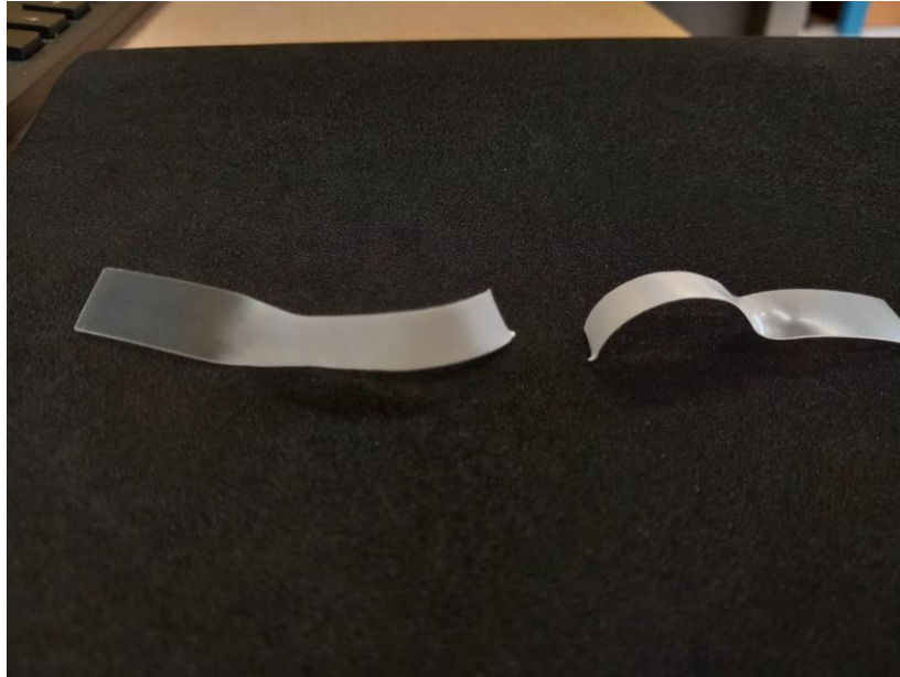
Figura 4.13 Provino di EVA+5% ZrP rotto in seguito a test di trazione
