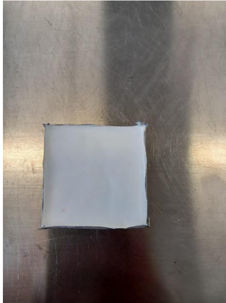
Figura 3.20 campione di EVA rivestito con film EVA+ 5% di ZrP (280 micron)
