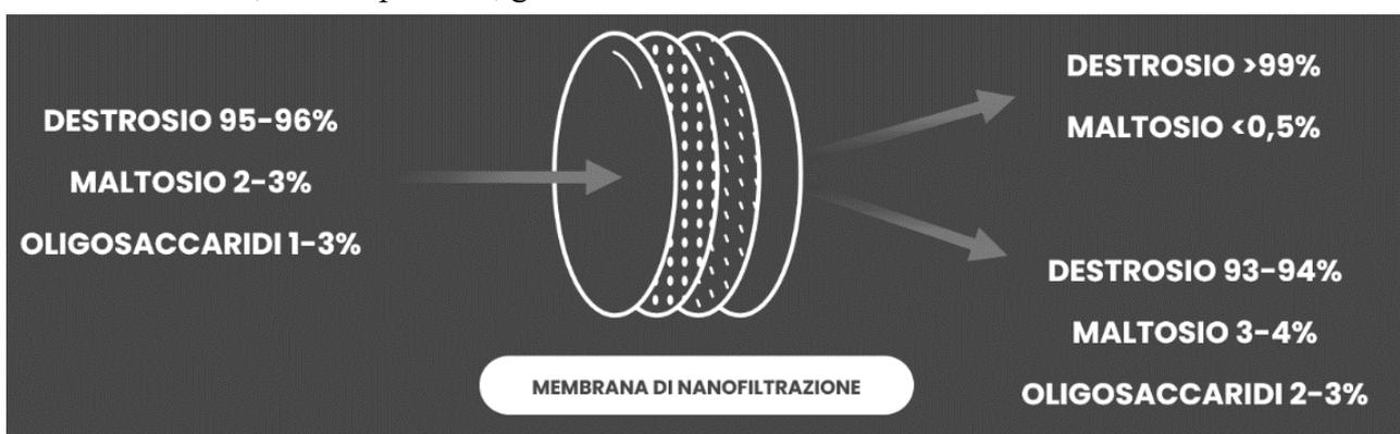
Figura 5.2 -Processo di Filtrazione a membrana Sedamyl,2018
