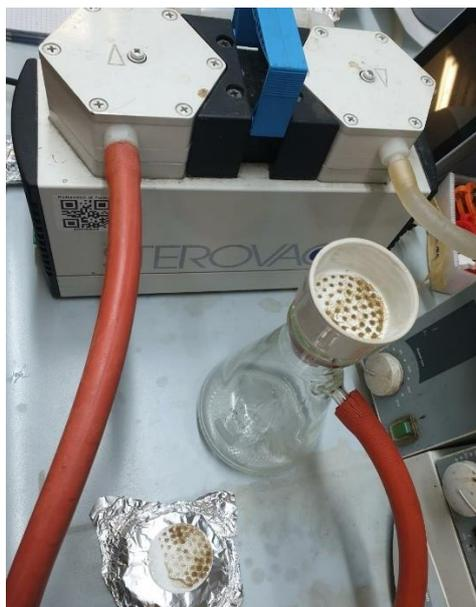
*Figura 5.5- Filtrazione brodo di coltura mediante pompa a vuoto*
