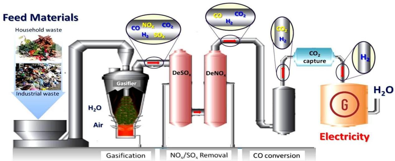
*Figura 3.2- Processo di Gassificazione della biomassa (Chi-Wang, 2018)*
