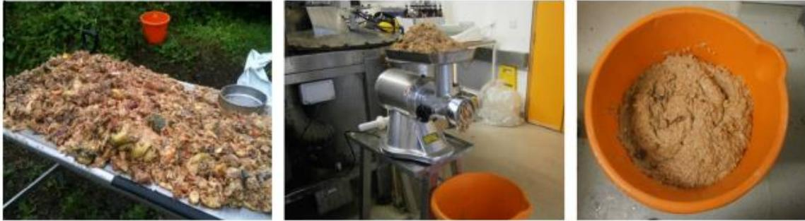
**Figura 11:** Triturazione e miscelazione della FORSU (Browne et al., 2013).
