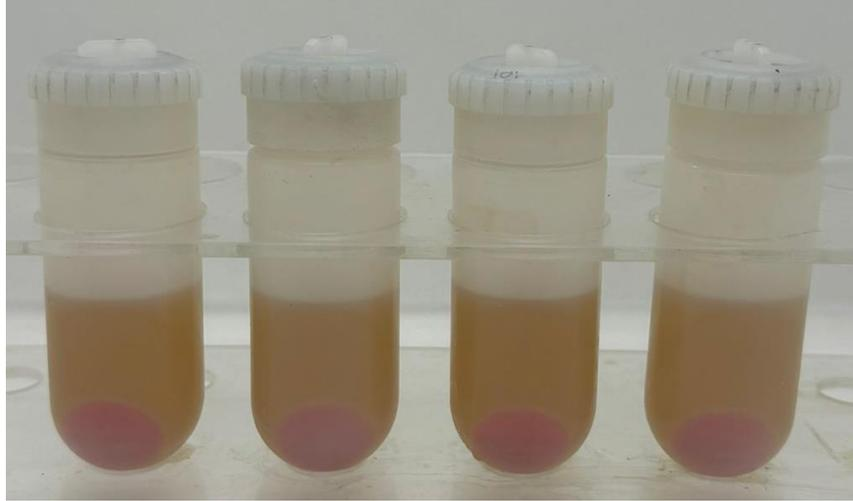
**Figura 31:** Pellet e surnatante risultante dopo il primo ciclo di centrifugazione.
