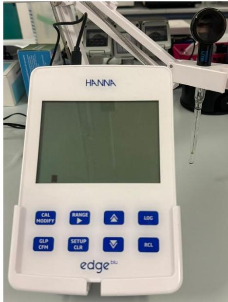
**Figura 26:** pH-metro Hanna Instruments con elettrodo HALO HI10832.
