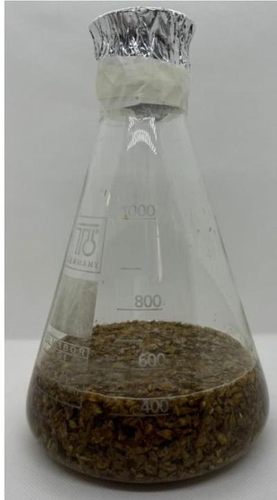
**Figura 18:** Miscela di BSG secca e acqua deionizzata in rapporto 1:5,81 (peso/volume) all'interno di una beuta prima dell'estrazione in autoclave.
