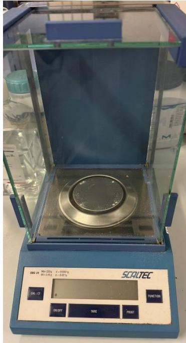
**Figura 14:** Bilancia SCALTEC SBC 31.
