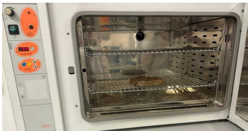
**Figura 13:** Campione di BSG poste in stufa.
