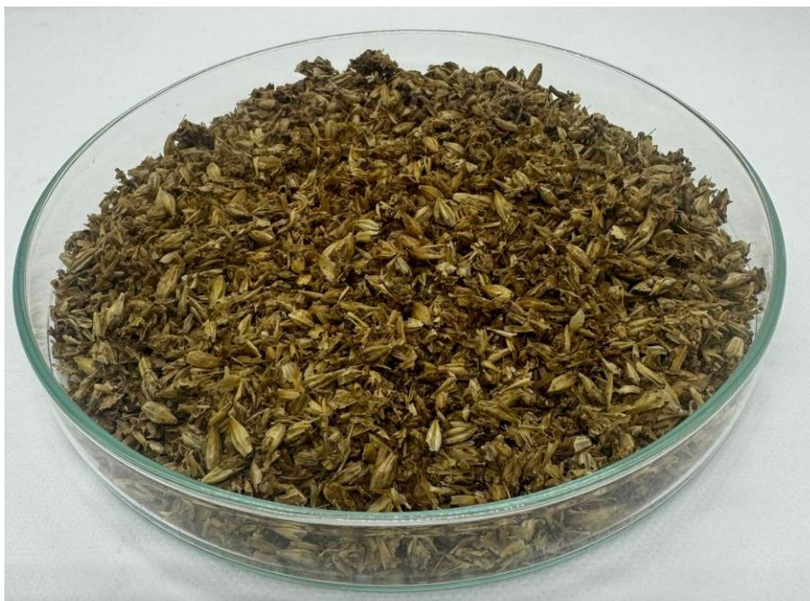
**Figura 17:** BSG dopo il processo di essiccazione in stufa.
