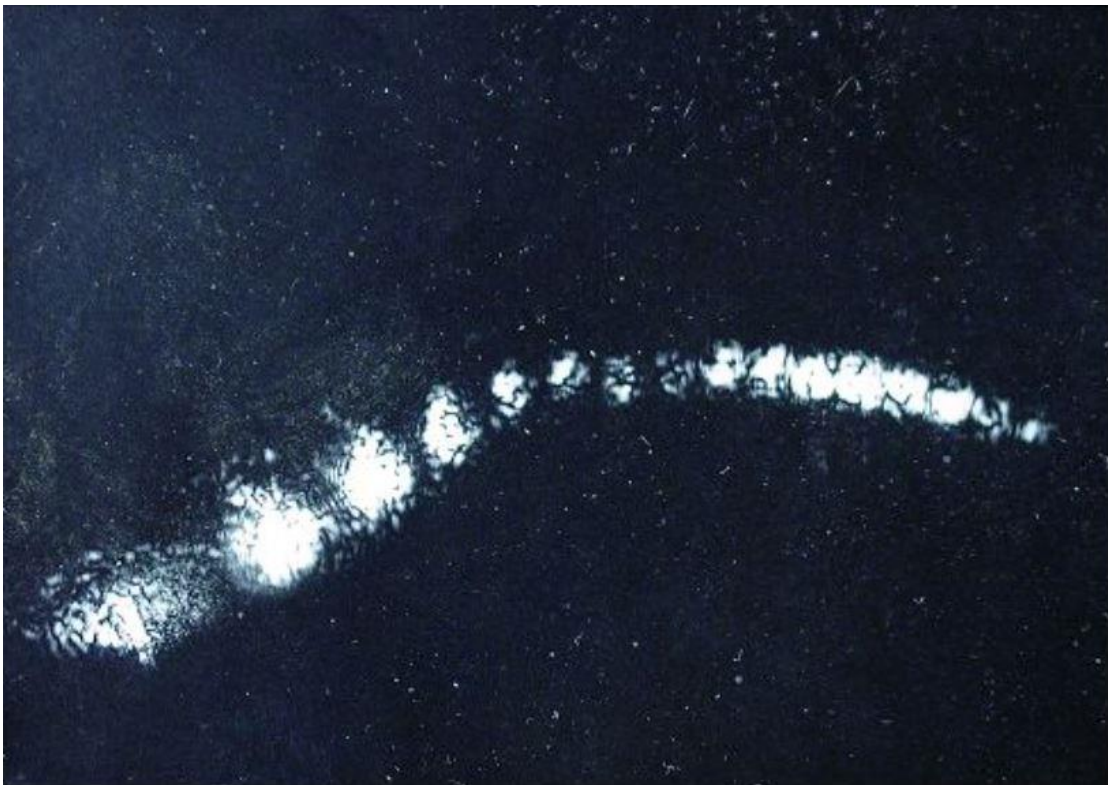
Figura 8_ Ologramma che dimostra la coerenza periodica dei nuovi laser con cavità 60 cm, ( Niels Bohr Library & Archives, https://repository.aip.org/islandora/object/nbla%3A283488#page/1/mode/2up )
