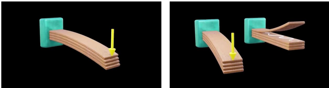
Figura 101_ trave sottoposta a carico verticale
