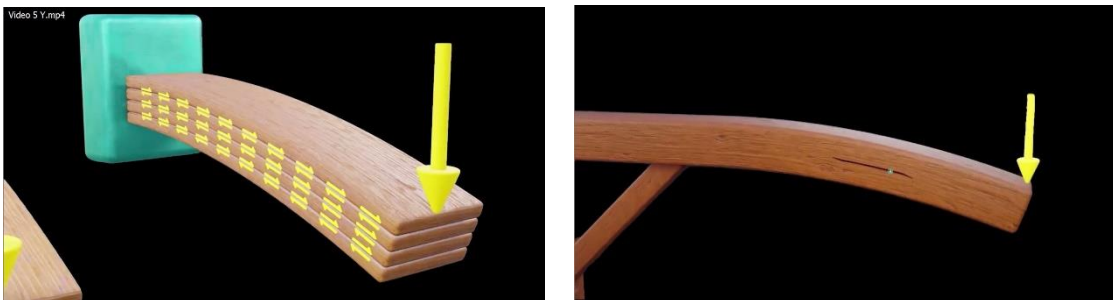
Figura 102_ assi di legno sottoposte ad una determinata forza, scivolano l'una rispetto all'altra
