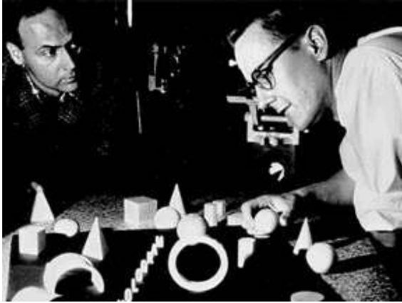
Figura 9_ Leith e Upatnieks riprendono un ologramma di trasmissione laser con la tecnica "fuori asse", (Fritz Goro for Life Magazine, 1967, http://www.holophile.com/history.htm )
