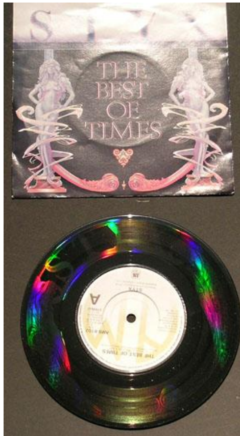
Figura 27_ reticolo di diffrazione olografica su disco LP, (Jonathan Ross Hologram Collection, http://www.jrholocollection.com/collection/foster.html )
