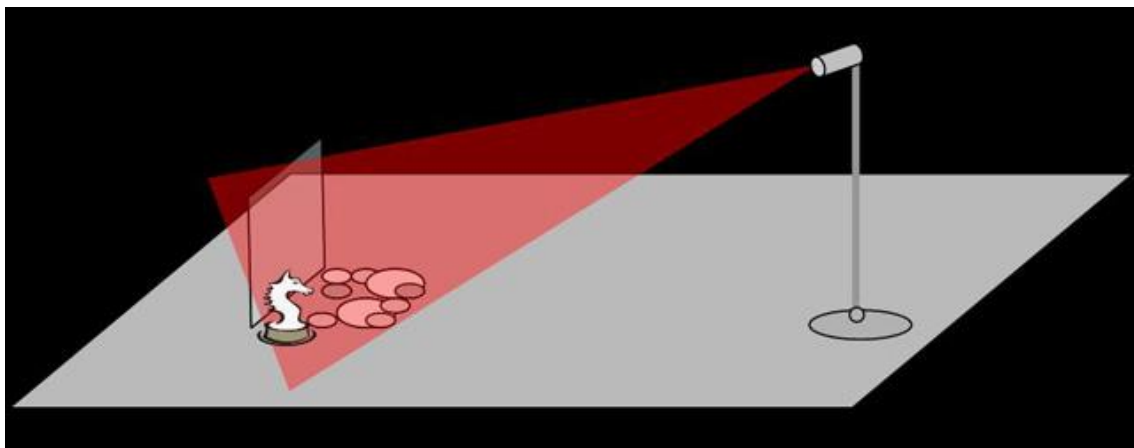
Figura 35_ la realizzazione di ologrammi di trasmissione 17 , (Integraf, https://www.integraf.com/resources/articles/a-how-to-make-transmission-holograms )
