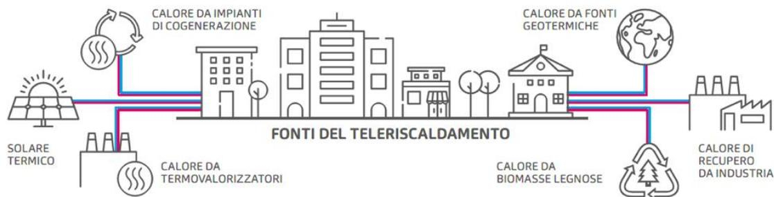
[Fig. 35] Schema sulle fonti alternative legate al teleriscaldamento. Fonte online: <https://www.a2acaloreservizi.eu/teleriscaldamento/come-funziona>
