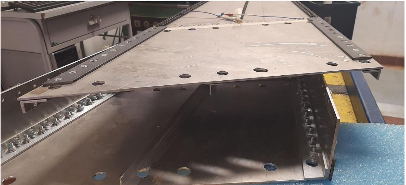
*Figura 5.2: sezione trasversale del pannello irrigidito*
