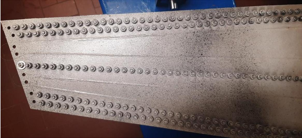
*Figura 5.17: trattamento della superficie per prova DIC*
