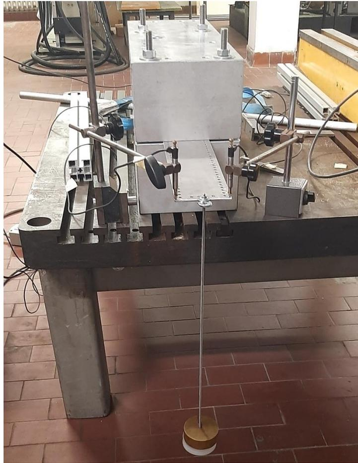
*Figura 5.9: prova statica - longherone*
