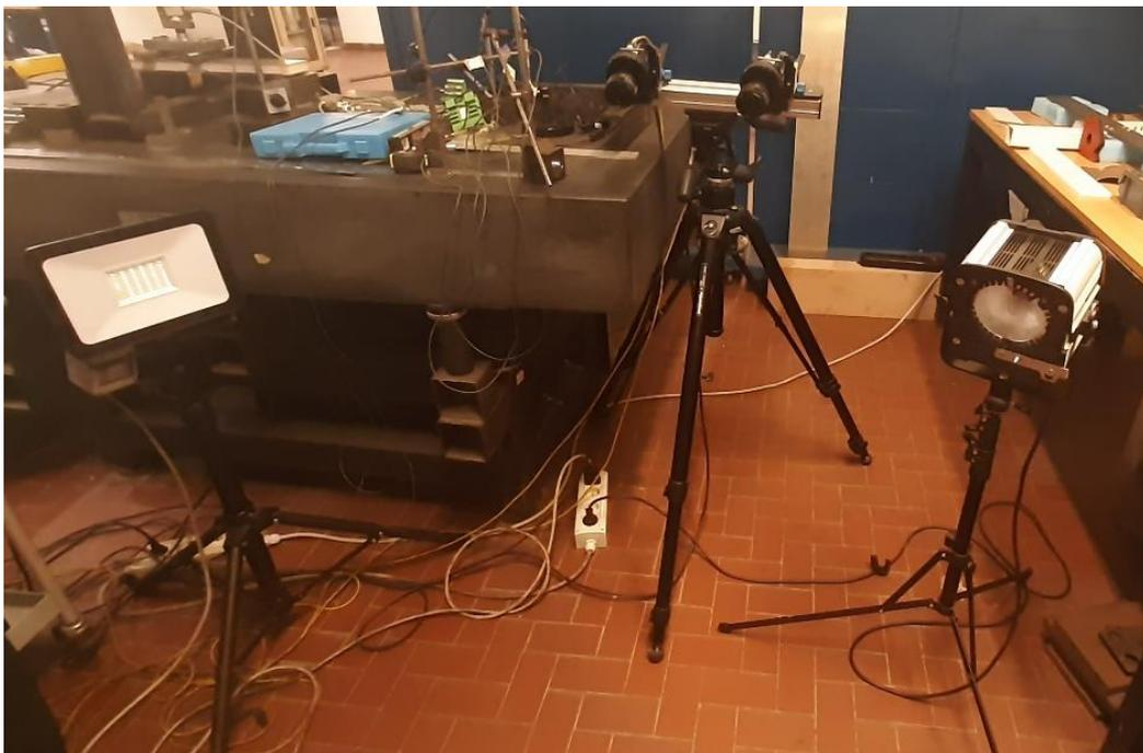
*Figura 5.18: fotocamere per la prova DIC*
