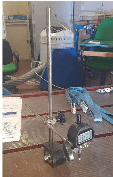
*Figura 5.5: LVDT con display integrato*
