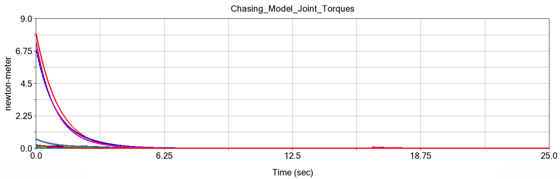
Figura 4.21 Coppie delle cerniere durante la fase di Dispiegamento
