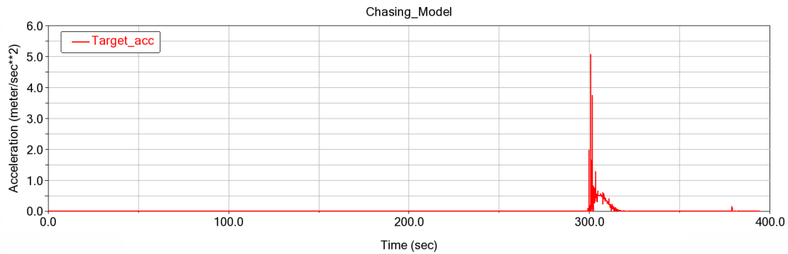
Figura 4.17 Andamento dell'accelerazione subita dal Target durante la cattura
