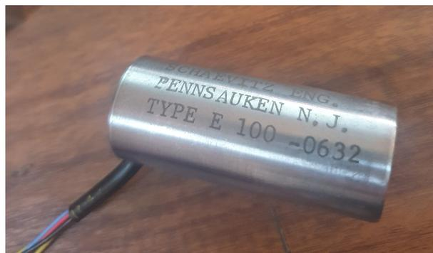
**Figura 3.1:** Cilindro cavo metallico che contiene al suo interno i 3 solenoidi ad assi paralleli che costituisce una parte del sensore LVDT
