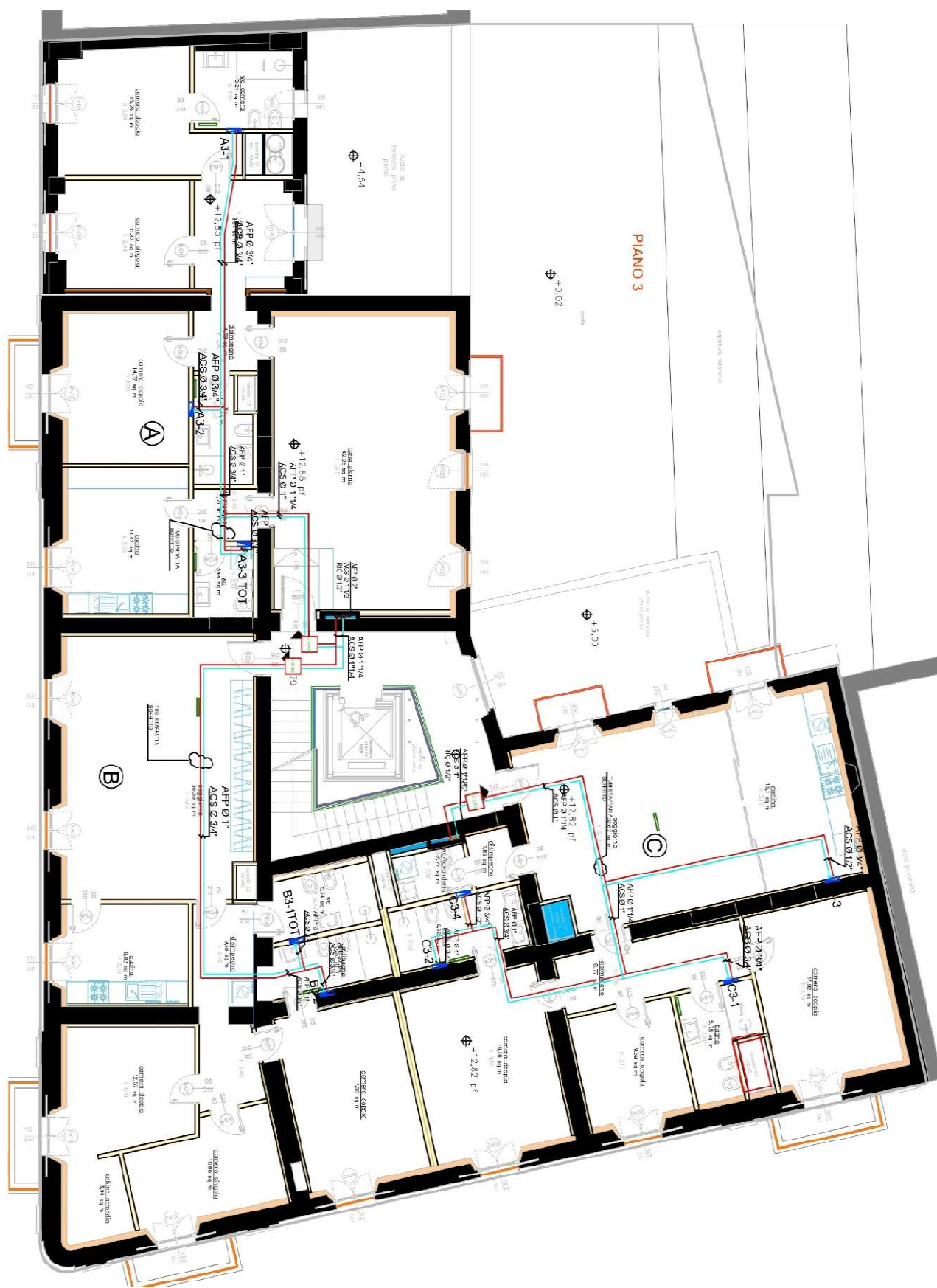
Figura 7.7 Distribuzione rete acqua sanitaria 3° piano
