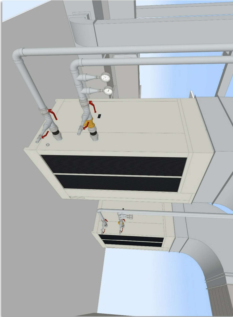
Figura 4.43 Collegamento impianto acqua tecnica a Chiller
