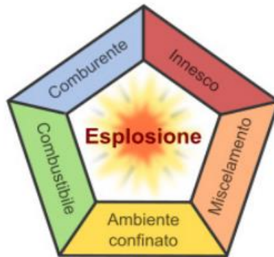
Figura 2- Il pentagono delle esplosioni da polveri
