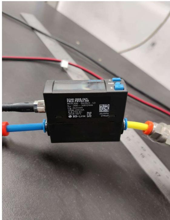
Figura 3.4: Fotografia del flussimetro.
