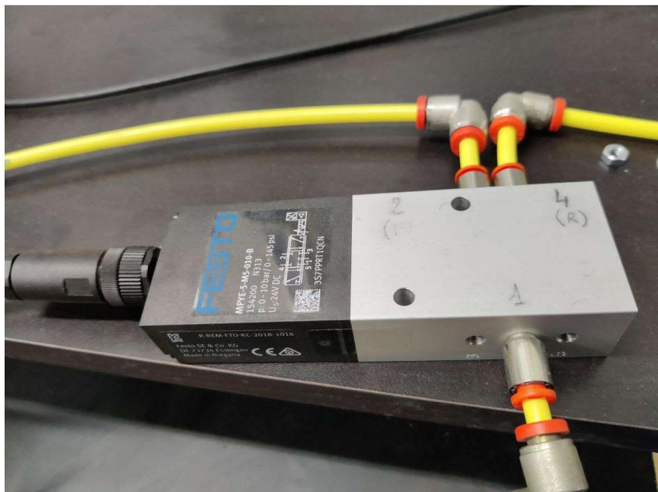
Figura 3.2: Fotografia della valvola proporzionale utilizzata.
