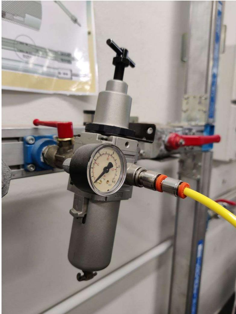
**Figura 3.5: Fotografia del regolatore di pressione.**
