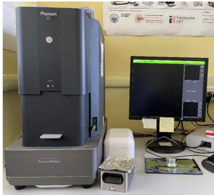
Figura 3.9: SEM Phenom XL utilizzato per la caratterizzazione morfologica
