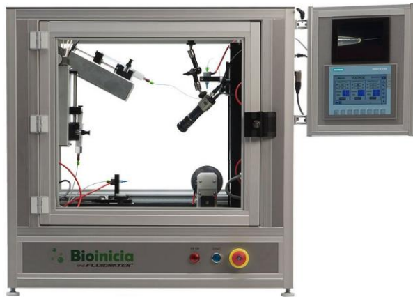
Figura 3.0: Fluidnatek LE-50 (Bionicia) usato per la produzione delle membrane
