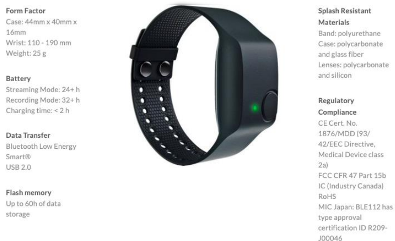
Figura 4.5 Specifiche tecniche orologio Empatica E4 ( https://www.empatica.com/en-eu/research/e4/ )
