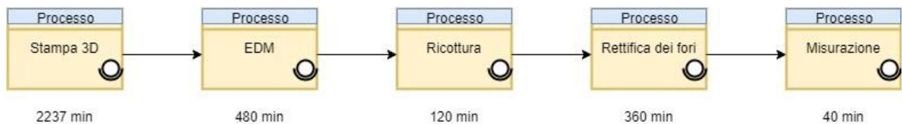
*Figura 36: SC produzione di un utensile del settore automotive con tecnologia AM*
