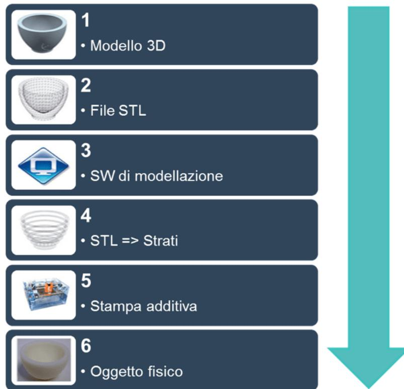
*Figura 4: schema fasi processo AM*
