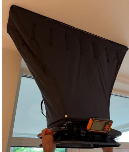
Figura 44 - Balometro Testo 420 con cono anemometrico 305x1200 mm
