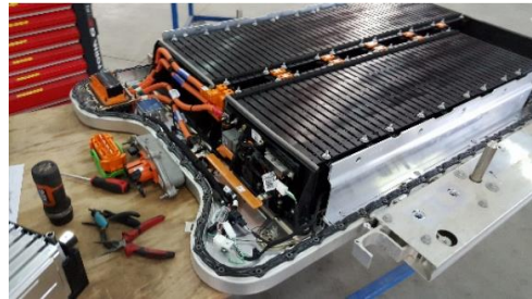
Figura 17.b, pacco batterie Renault Zoe
