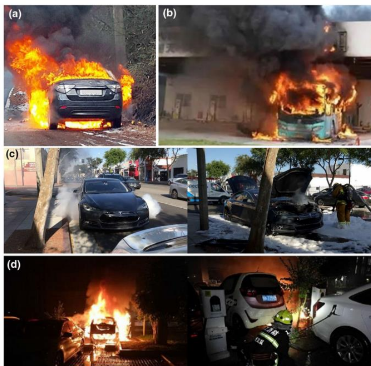
Figura 92, Tipici incidenti di incendio di veicoli elettrici negli ultimi anni: a) veicolo elettrico Renault-Samsung modello "SM3.Z.E" ha preso fuoco durante la guida il 15 gennaio 2016 in Corea [396]; b) L'autobus elettrico in cui pure batteria ha preso fuoco in una stazione di ricarica il 26 aprile 2015, Shenzhen, Cina, e questo autobus elettrico non era in carica quando ha preso fuoco [397]; c) La Tesla Model S ha rilasciato fumo durante la guida il 15 giugno 2018 in California, USA, e l'incendio è stato spento iniettando 1135 litri di acqua e schiuma [398]; d) l'incendio di un veicolo elettrico è avvenuto in un parcheggio il 20 maggio 2018, Hangzhou, Cina [399].
