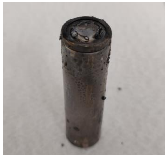
Figura 147, cella in seguito alla prova di surriscaldamento.
