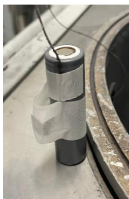
Figura 121, disposizione del cemento a contatto con la cella.
