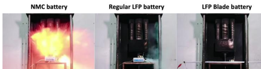
Figura 49. Test di penetrazione dei chiodi per NMC, LFP normale e batteria a lama [199], [202].
